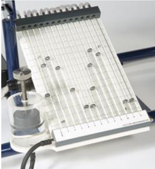
BANCO DE MANÓMETROS INCLINADOS
