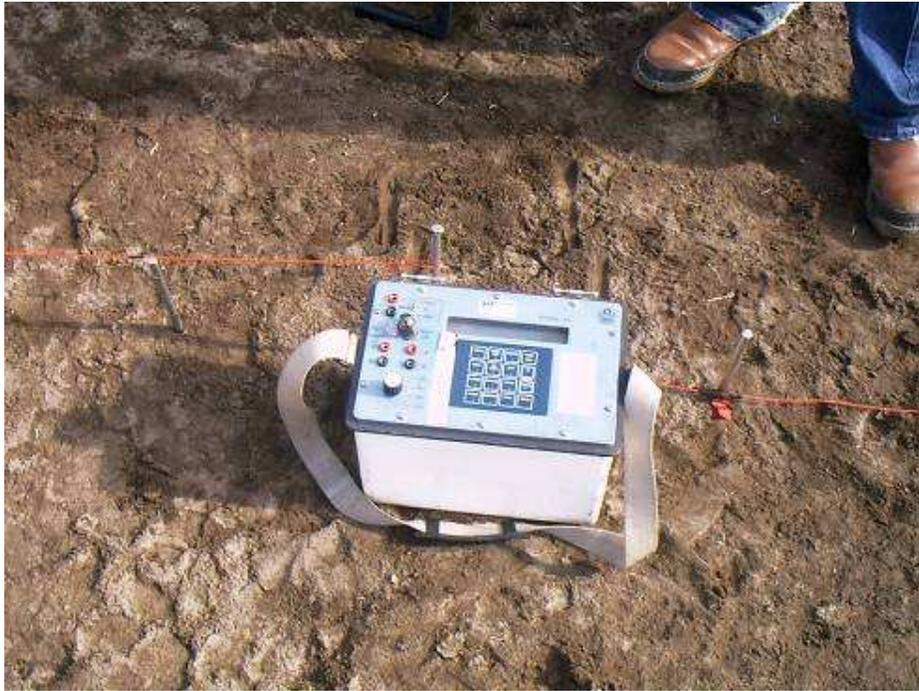
**Foto 3. Equipo utilizado (Syscal R1 Plus)**
