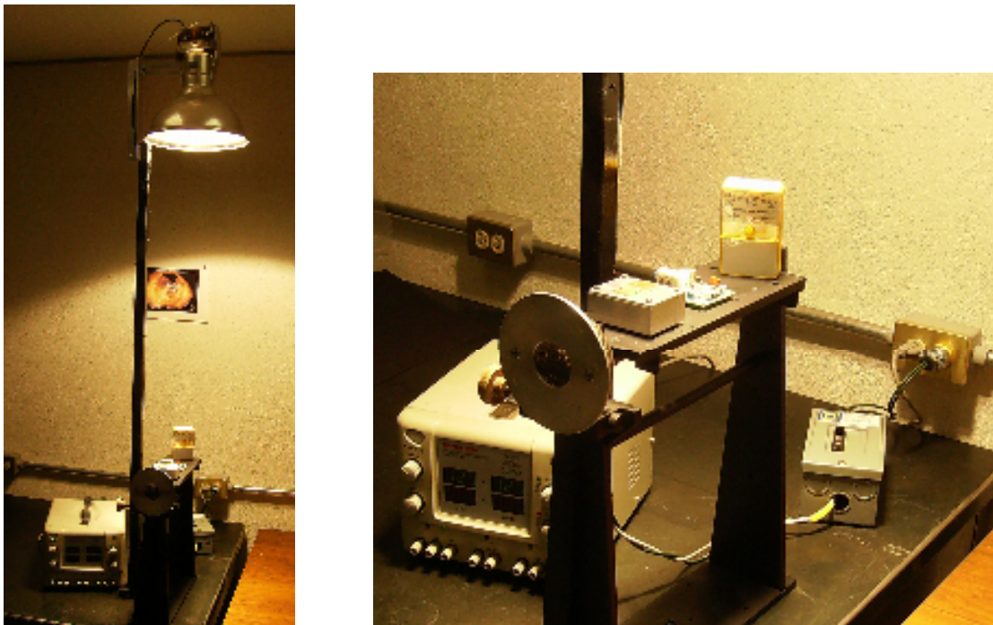
Figura 4.7. Fotografía del arreglo experimental, donde se aprecia el sensor de sol, la lámpara, la brújula y el medidor de potencia lumínica.
