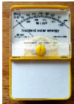
Figura 4.11. Equipo utilizado para la medición de la potencia lumínica, directamente en W/m^2 . En su parte superior cuenta con una celda solar calibrada.
