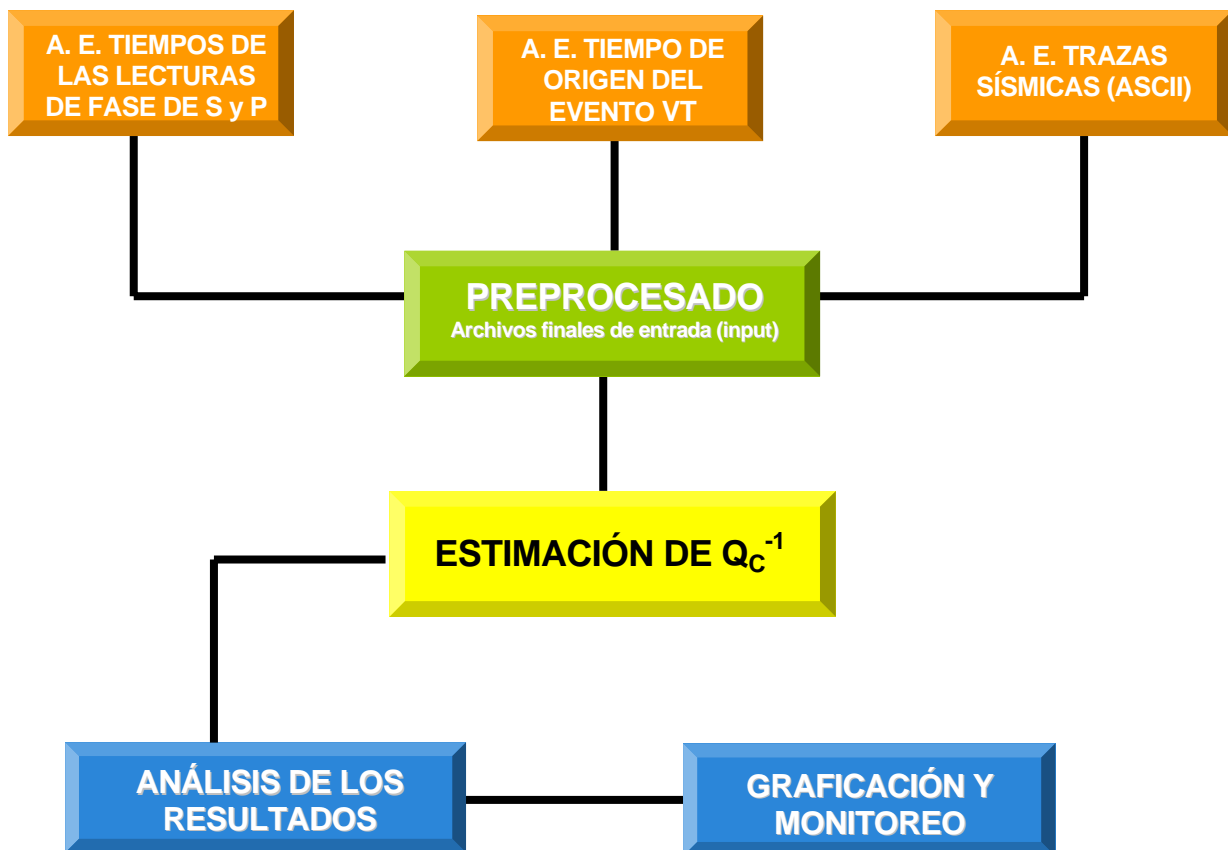
Figura 15. Esquema general del funcionamiento del programa ESTIMACION QC. Los primeros tres cuadros indican el tipo de archivos de entrada (A. E.) con los que trabaja el programa.
