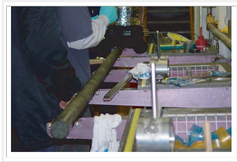
Figura IV.31. Recuperación de un núcleo previo a las mediciones en el pozo (Goldberg et al., 2004).
