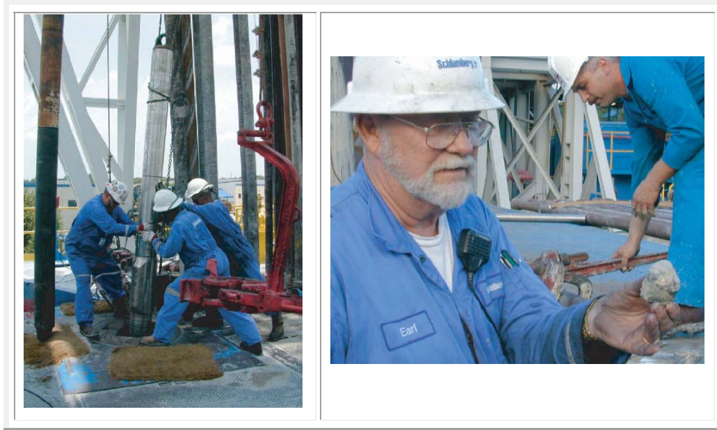
Figura II.3.14. a) Pruebas y registros durante la extracción de núcleos en una torre de *Schlumberger. b) Prueba exitosa de una muestra de núcleo con RAB-8 (Goldberg et al., 2004).
