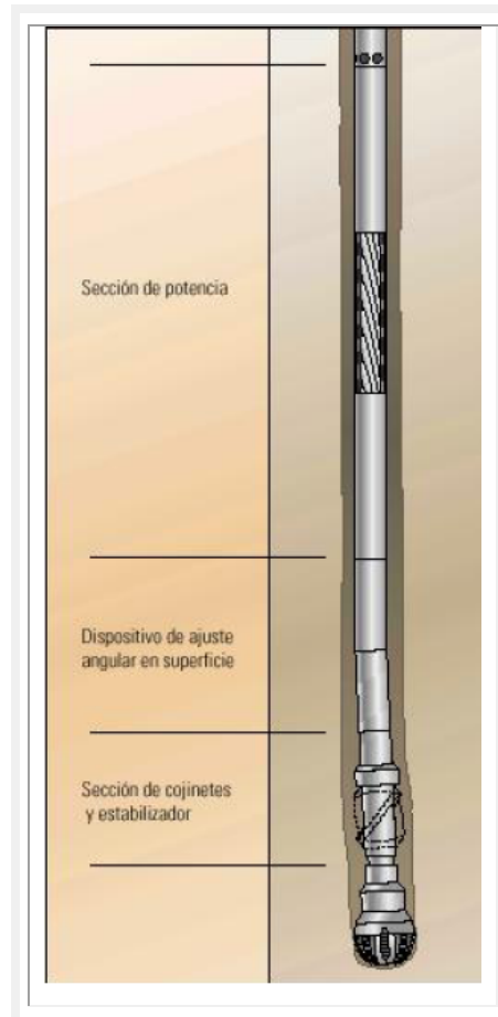
Figura II.1.44. Herramienta Power Pak de perforación direccional (Downton et al., 2000).
