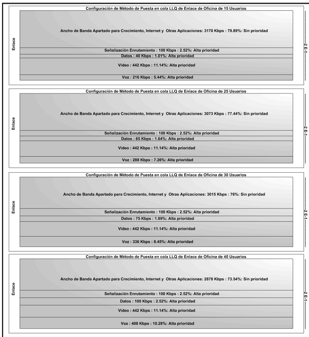
Figura 47: Diagrama de carga de enlace para LLQ de propuesta de red basada en VPN.
