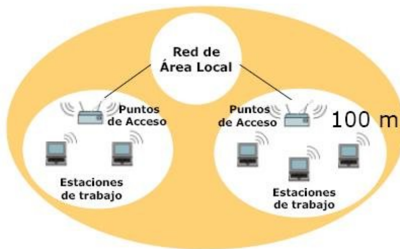
Figura 1.18 Estructura de una red de infraestructura.
