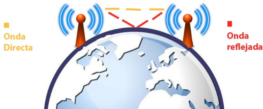
Figura 1.7 Enlace de microondas de línea de vista
