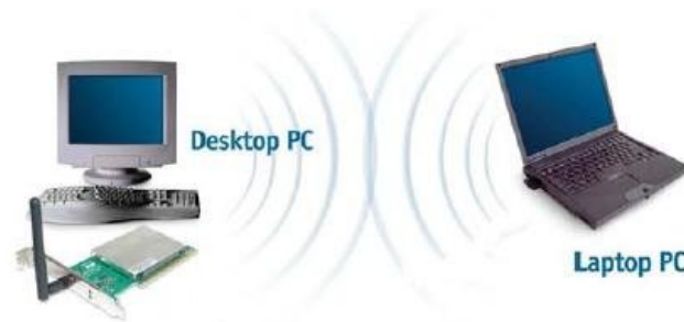
Figura 1.19 Estructura de una red Ad-HOC.
