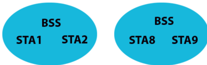
Figura 2.1 Representación de las celdas BSS
