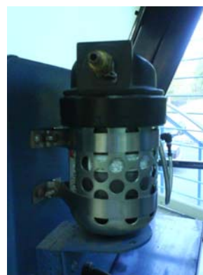
Figura III.2 Trampa de agua
