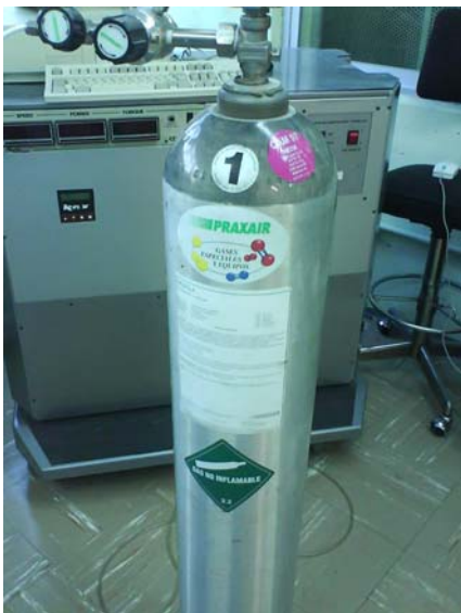
Figura VI.1 Tanque de la mezcla de gases para la prueba del analizador de gases
