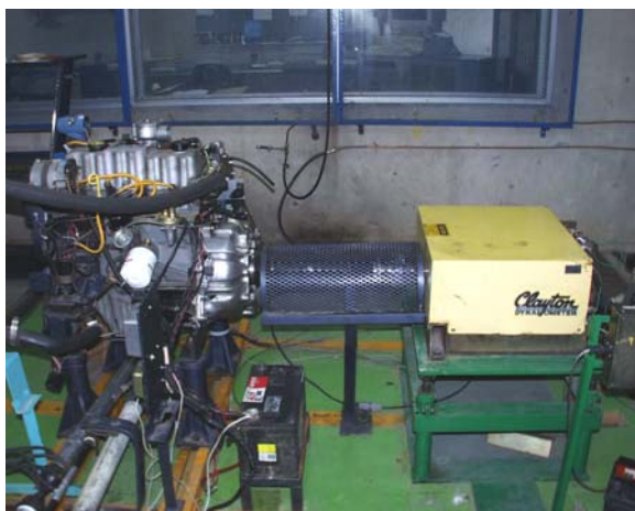
Figura III.11 Dinamómetro de Motor, manufacturado por Clayton.
