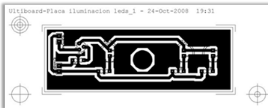
Figura VII.3 Negativo para estampado de PCB.
