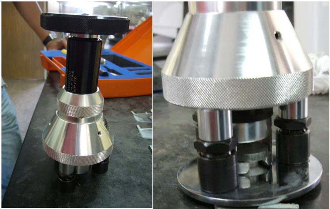
Fig. 21. Aparato para la prueba de adherencia.
