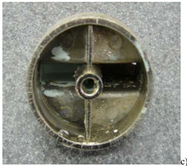
Fig. 39. Polibutil tereftalato (PBT) expuesto a 250°C por 20 min.
