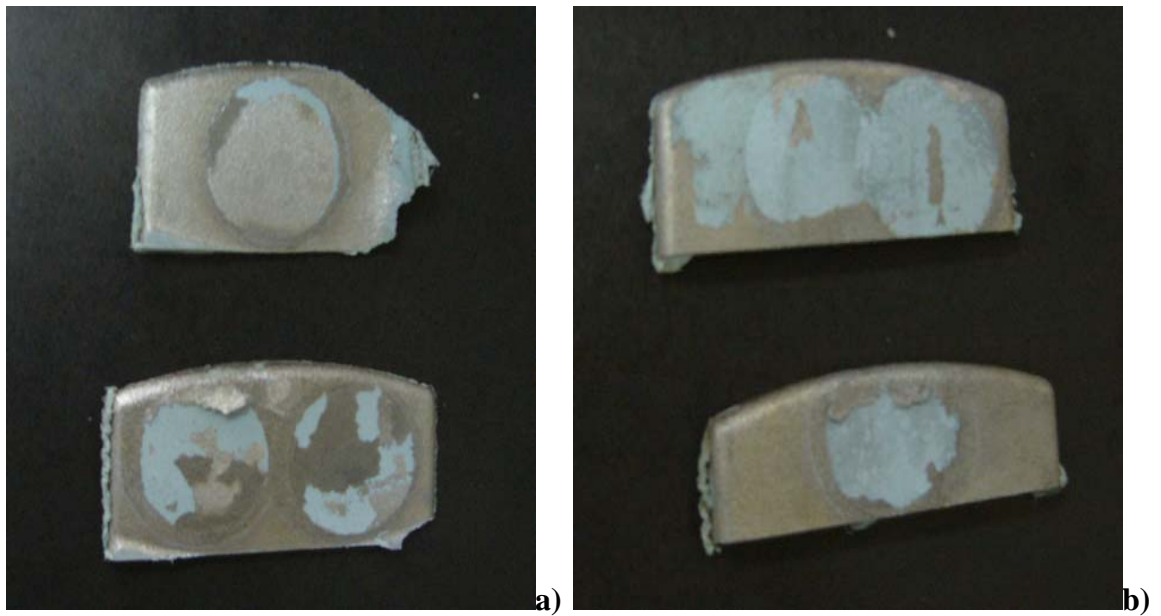
Fig 32. Resultado de la prueba de adherencia para el PBT con a) 25 min y b) 40 min de exposición de ataque.
