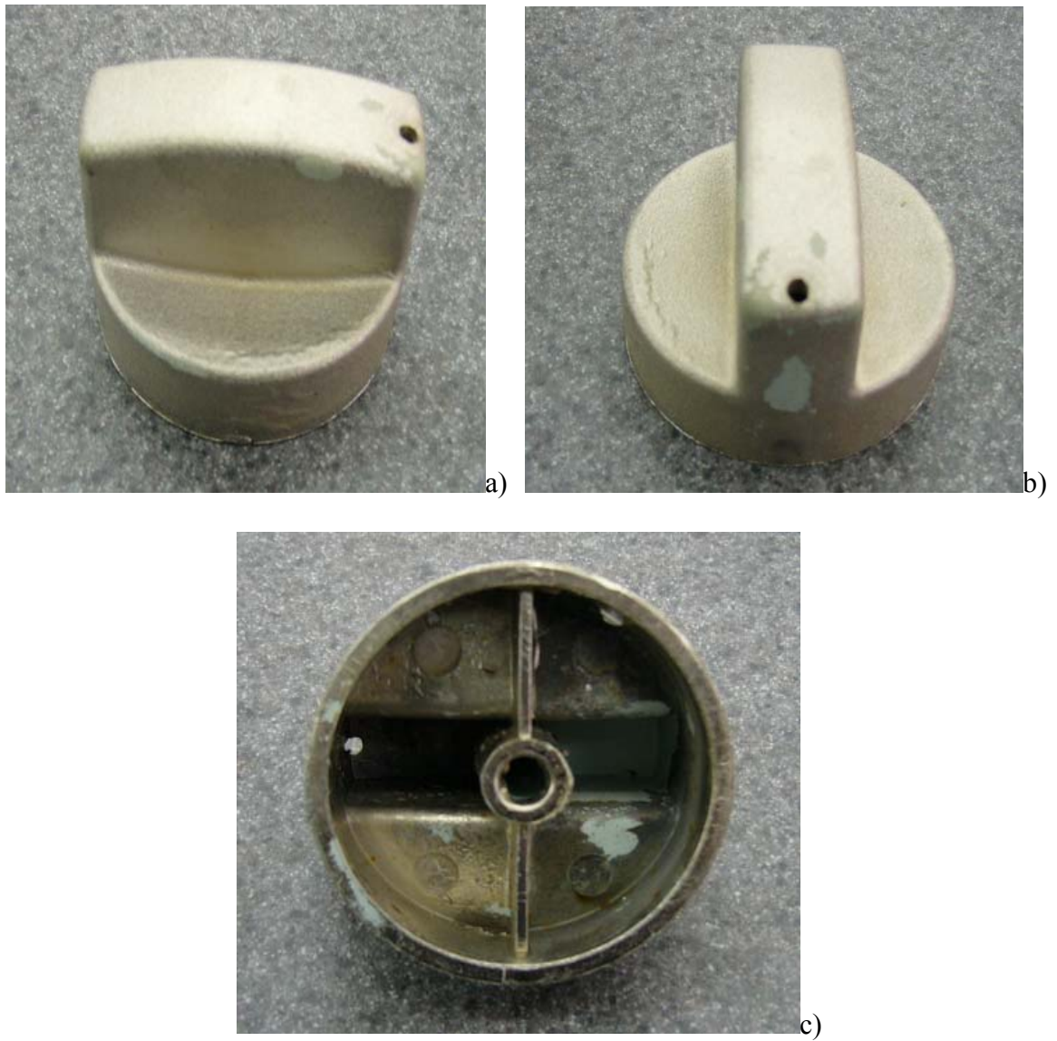
Fig. 38. Polibutil tereftalato (PBT) expuesto a 230°C por 20 min.
