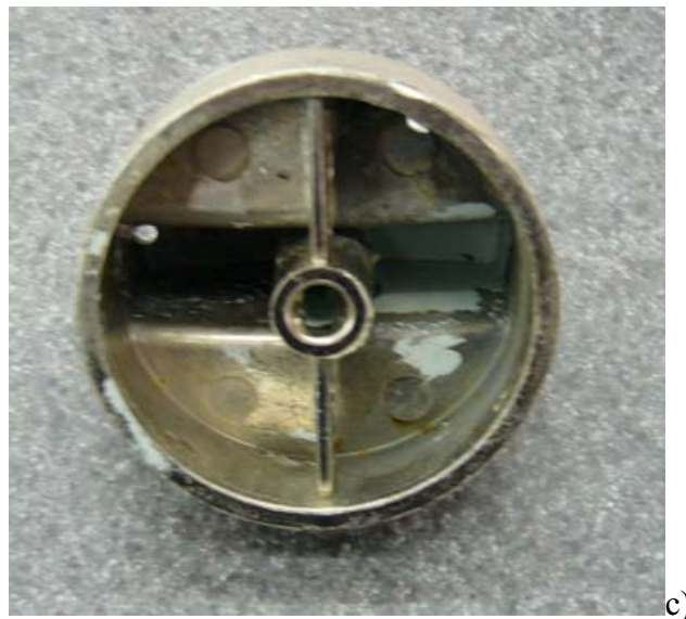
Fig 36. Polibutil tereftalato (PBT) expuesto a 200°C por 20 min.
