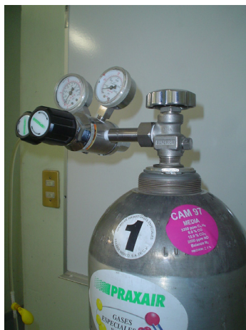
Figura VII.1. Tanque con gases contaminantes de ajuste.
