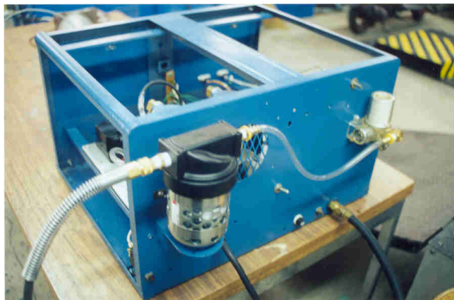
Figura III.1. Aspecto físico del analizador de gases integrado en el LCE.
