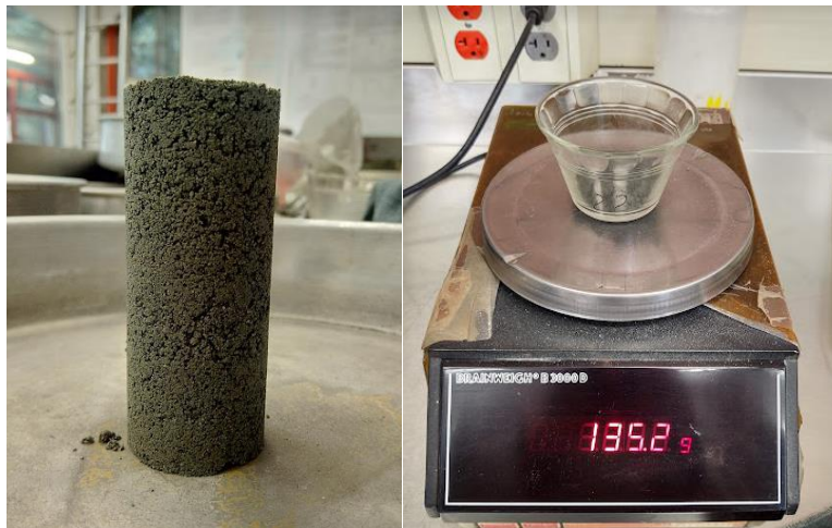
Figura 4.4 a) Probeta desmoldada, b) Toma peso de muestra para determinar contenido de agua.
