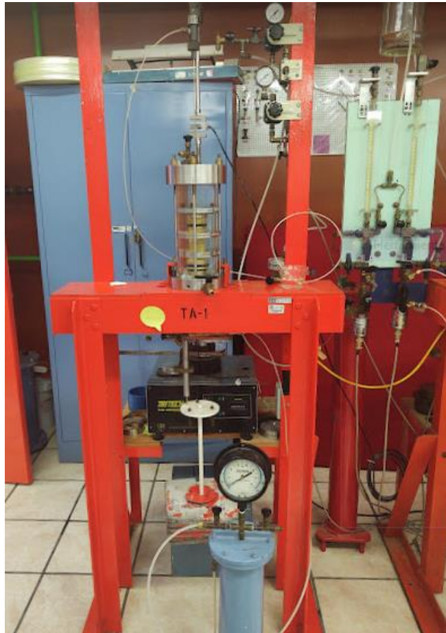
Figura 4.9 Circulación de CO 2 en la muestra.
