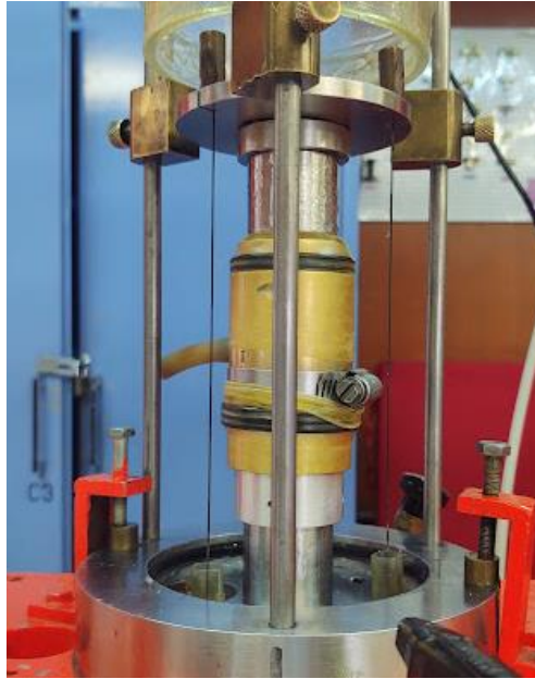
Figura 4.8 Montaje de la muestra en la cámara triaxial.
