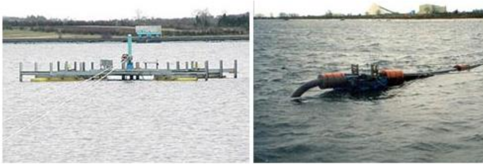
Figura 1.5 Deposición subacuática dentro de un embalse convencional (Engels, 2020).
