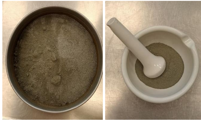
Figura 4.3 Homogenización del material en seco
