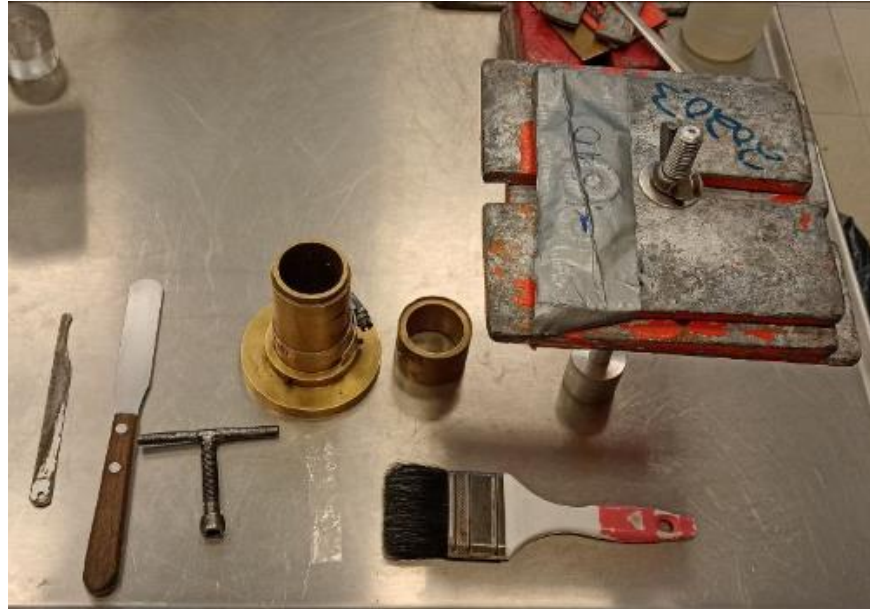
Figura 4.5 Implementos usados en la formación de probetas para las pruebas de compactación.
