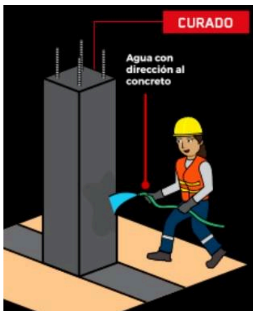
Figura 60. Ilustración del curado de concreto.
