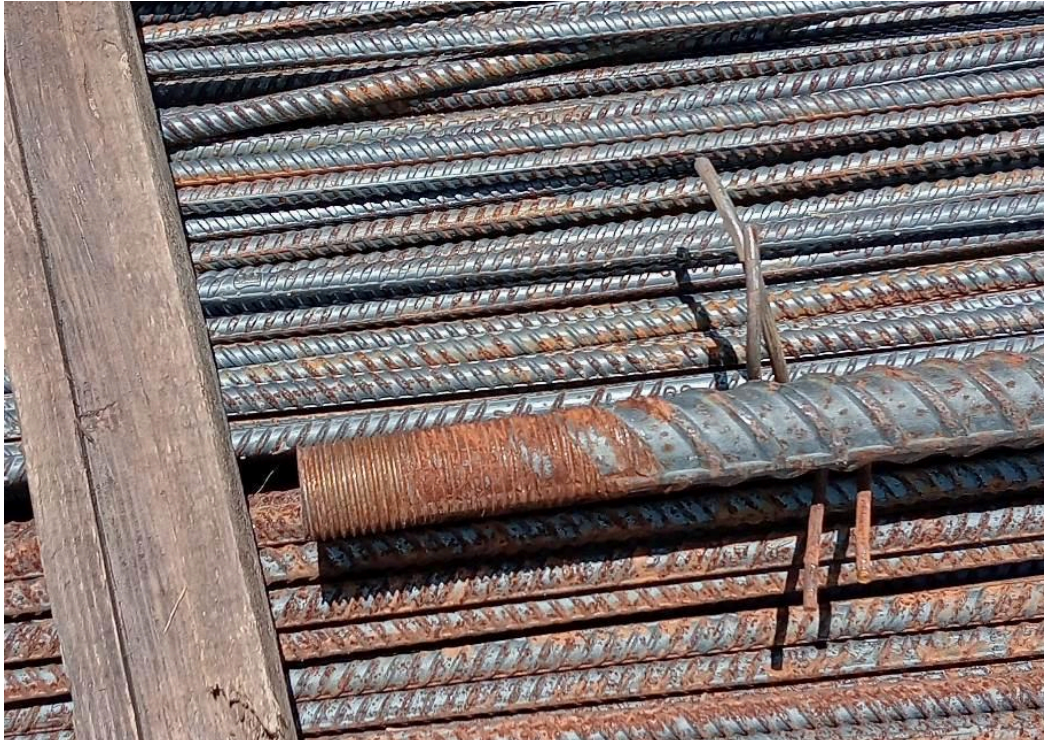
Figura 87. Cuerda en un extremo de una varilla de acero corrugado utilizada para las columnas de la construcción del ejemplo.
