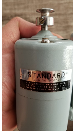
Figura 3.17: Motor CA utilizado en las pruebas de funcionamiento.
