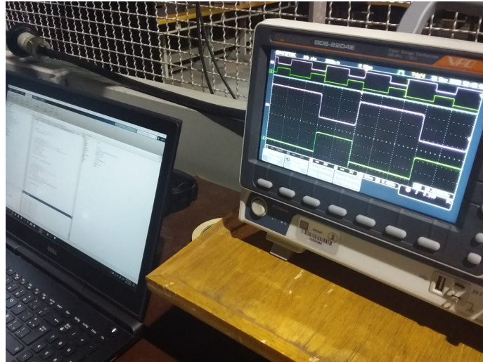
Figura 4.9: Doble PWM mediante compuerta CMOS generada a través de la Tiva.
