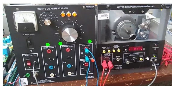
Figura 4.3: Prueba de funcionamiento de la fuente de alimentación y motor previstos para el sistema.
