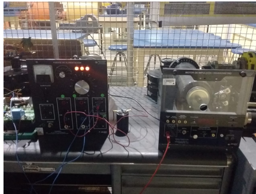
Figura 4.11: Montaje de sistema de control CD para pruebas utilizando el capacitor auxiliar.
