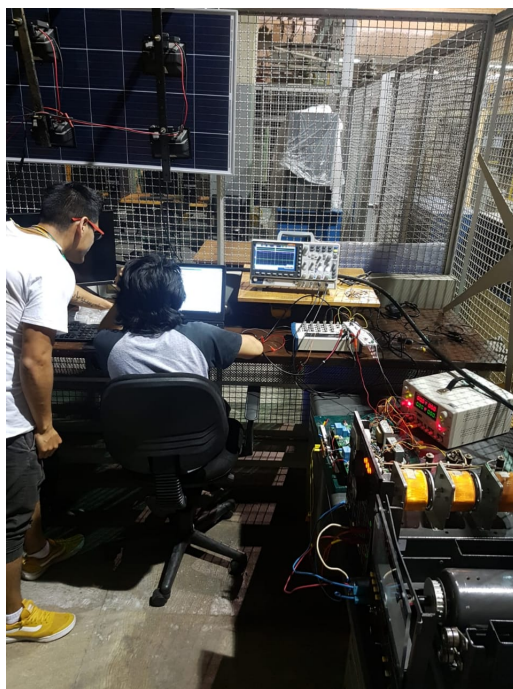
Figura 4.10: Prueba de funcionamiento del sistema de control CD armado en su totalidad.
