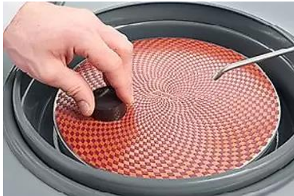
Figura 58. Muestra siendo lijada por un disco abrasivo. [54]
