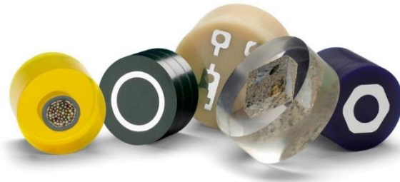
Figura 56. Ejemplos de muestras encapsuladas en bakelita y resina acrílica. [53]
