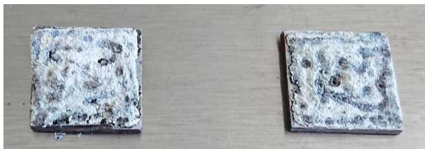
Figura 23. Capa de óxido formada en la superficie de las placas después de la etapa de recubrimiento.
