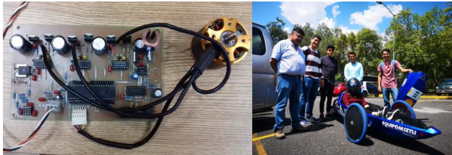
Figura 1. Prototipo para el control electrónico de un motor BLDC usado en un vehículo eléctrico.
