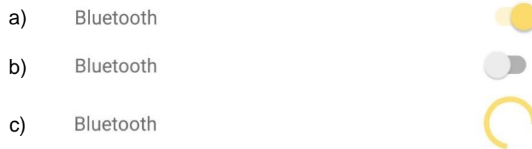
Figura 19. El SwitchCompat que controla el estado del bluetooth cuando está a) encendido, b) apagado y c) el ProgressBar que lo remplaza mientras se realiza el cambio.
