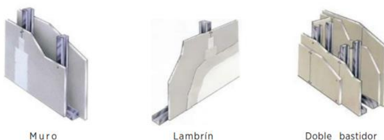
Ilustración 15. Distintos tipos de muros de Tablaroca y Durock de acuerdo con su configuración en el armado de bastidor. USG (2023). Manual técnico USG Tablaroca. Recuperado el 28 de septiembre de 2023, de https://www.usg.com/content/usgcom/spanish/resource-center/manual-tecnico-tablaroca.html página 11
