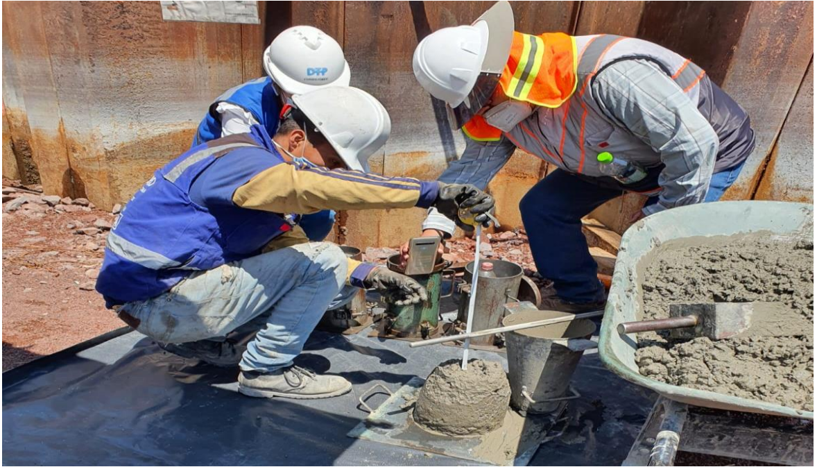
Imagen 44: Pruebas para calidad del concreto.
