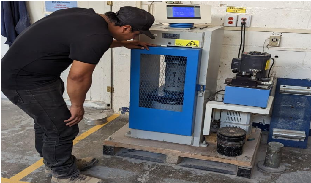
Imagen 68: Prueba a compresión de cilindro de ensayo estándar.
