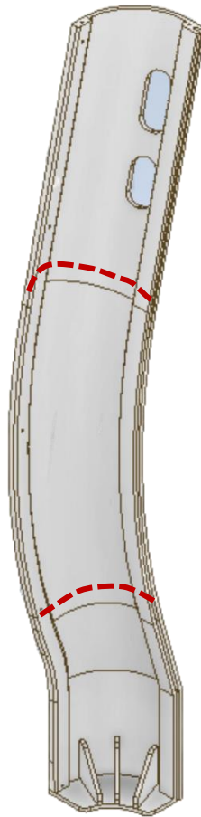
ILUSTRACIÓN 89. ESTRUCTURA DE LOS SOPORTES LATERALES DE LA CARCASA (IMPRESOS EN 3D FFF).
