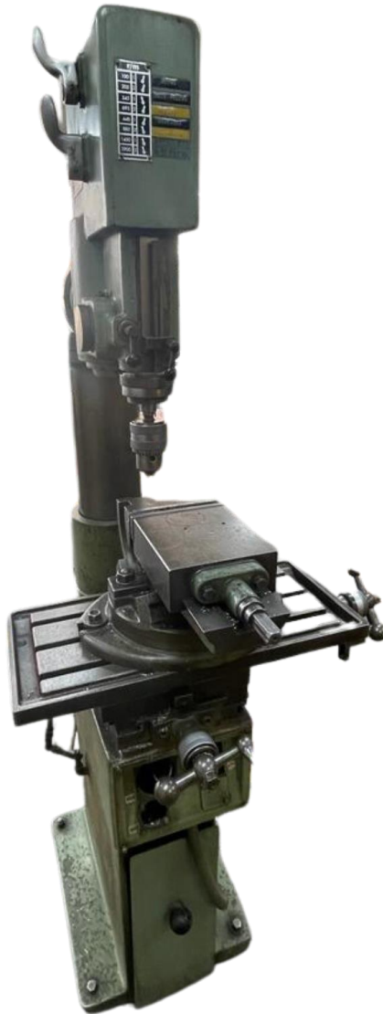
ILUSTRACIÓN 85. TALADRO DE BANCO UTILIZADO EN LA MANUFACTURA (MARCA AB ARBOGA MASKINER ).
