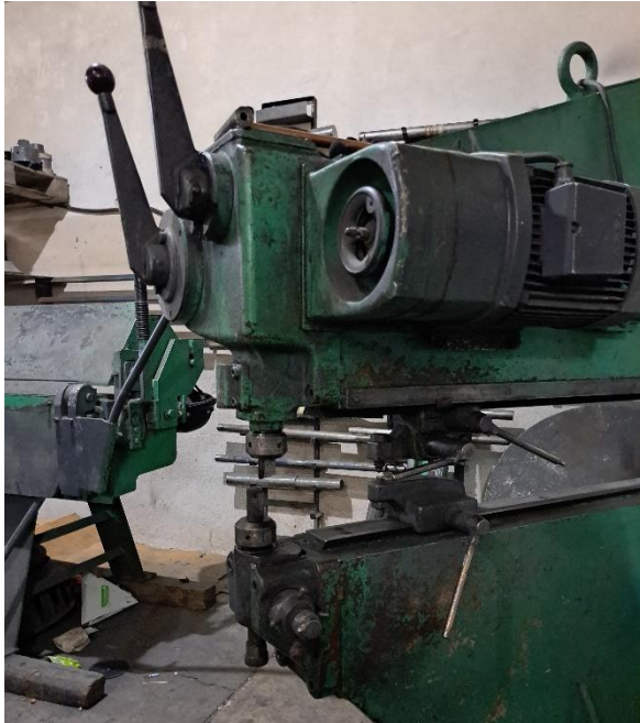
Fig. 6: Nibladora empleada para cortes circulares. Fig. 7: Soporte de pie de rodamiento empleado para el PLR del caso de estudio.
