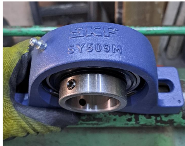
Fig. 6: Nibladora empleada para cortes circulares. Fig. 7: Soporte de pie de rodamiento empleado para el PLR del caso de estudio.
