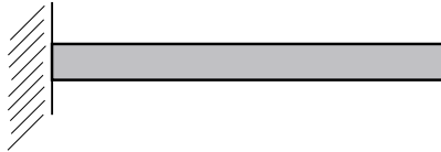
Imagen 7. Viga en cantiléver.
