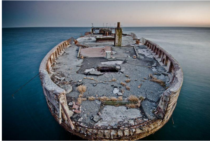
Imagen 24. Barco fabricado con ferrocemento.
