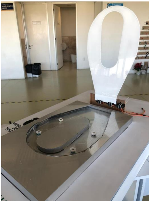
Figura 36. Cámara de limpieza y asiento.
