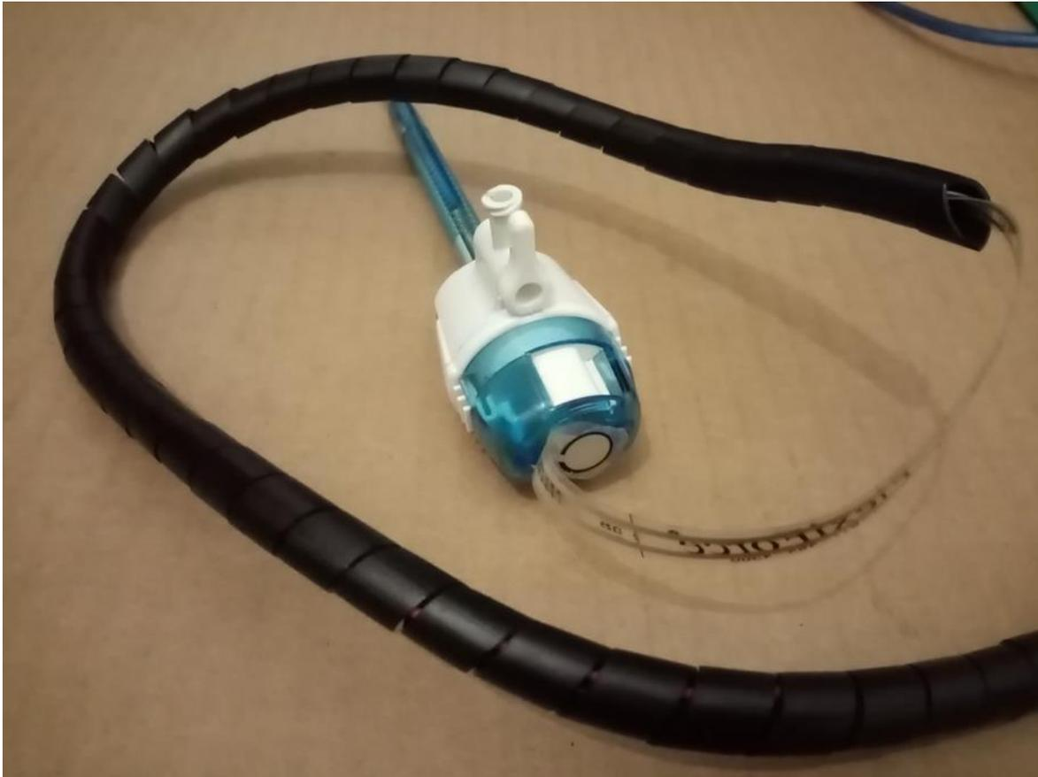
*Figura 22 Colocación del sensor de fuerza en el trocar*
