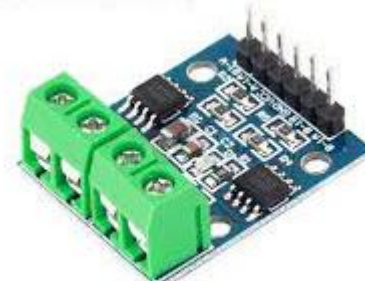
Figura 20. Drivers I9119S. Elaboración propia.
