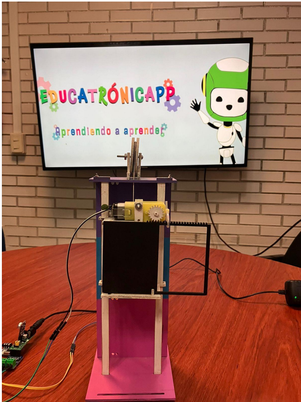
Figura 21. Prototipo base para pruebas de robot elevador. Elaboración propia.
