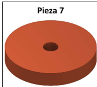
Figura 21. Pieza fabricada manualmente con taladrado y cizallas
