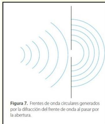
Figura 7. Frentes de onda circulares generados por la difracción del frente de onda al pasar por la abertura.
