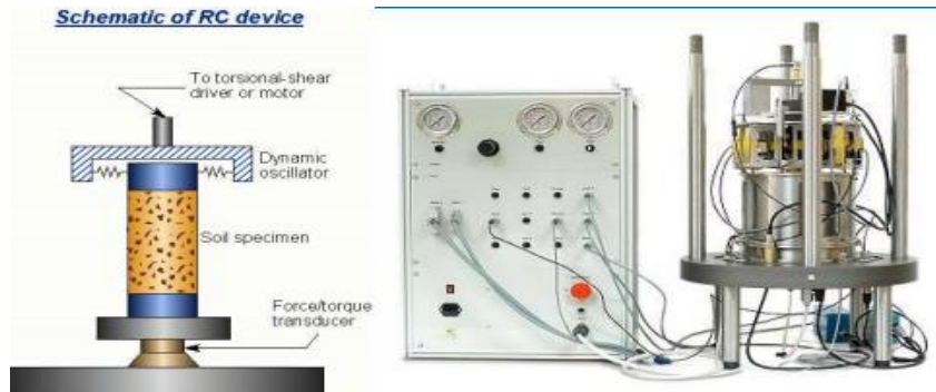
Imagen 4.3-4: Prueba de la columna resonante. (Diaz, 2021)
