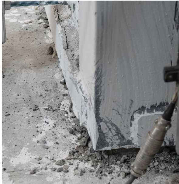
Fig. 3.3.193 Evolución del daño (R=3%) - Columna C-4 (Instituto de Ingeniería, 2021 - 2023)
