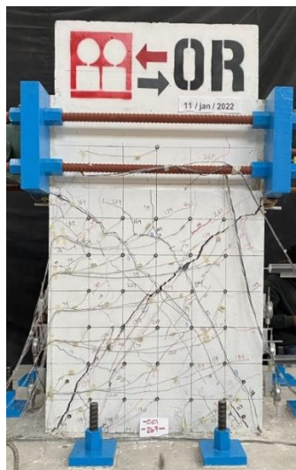
Fig. 3.3.45 Aplastamiento del espécimen ( R=-1\% ) - Columna OR (Instituto de Ingeniería, 2021 - 2023)
