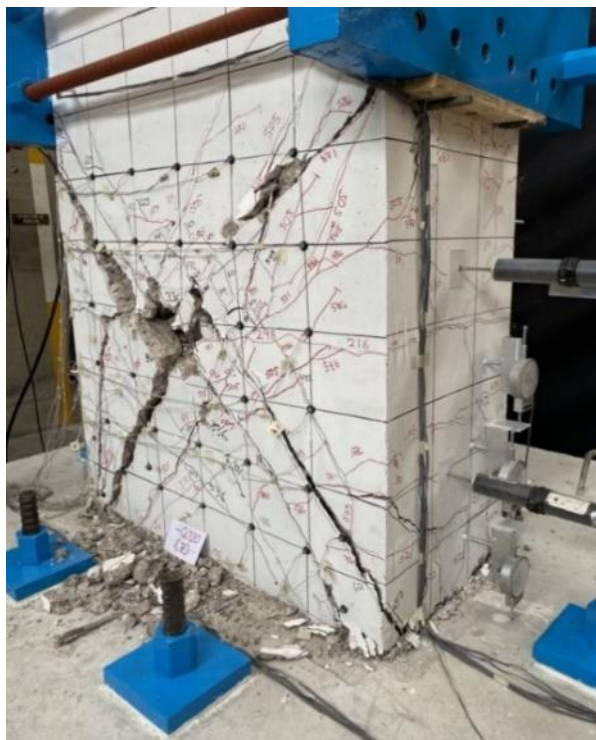
Fig. 3.3.13 Column O cara oeste ( R=2\% ) (Instituto de Ingeniería, 2021 - 2023)
