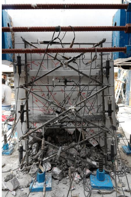
Fig. 3.3.210 Estado final del daño cara sur - Columna C-4 (Instituto de Ingeniería, 2021 - 2023)
