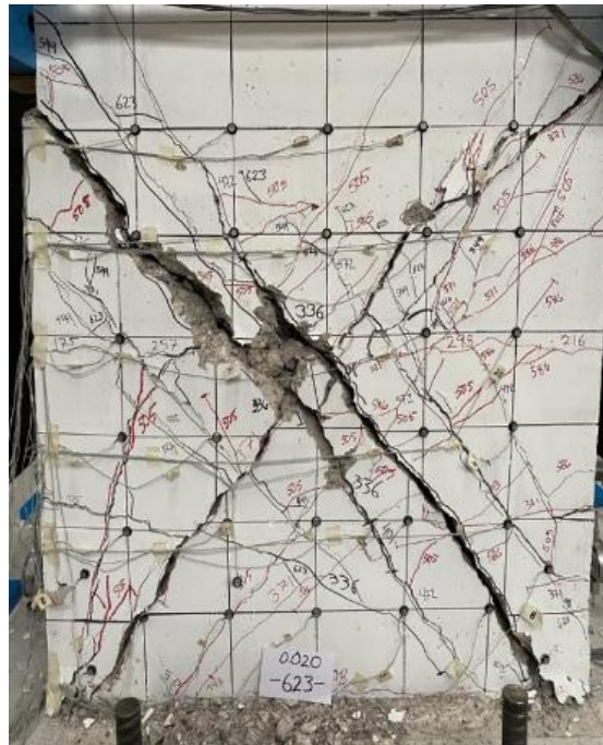
Fig. 3.3.11 Columna O (R=2%) (Instituto de Ingeniería, 2021 - 2023)
