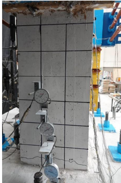
Fig. 3.3.69 Aparición de la primera grieta - Columna O* (Instituto de Ingeniería, 2021 - 2023)
