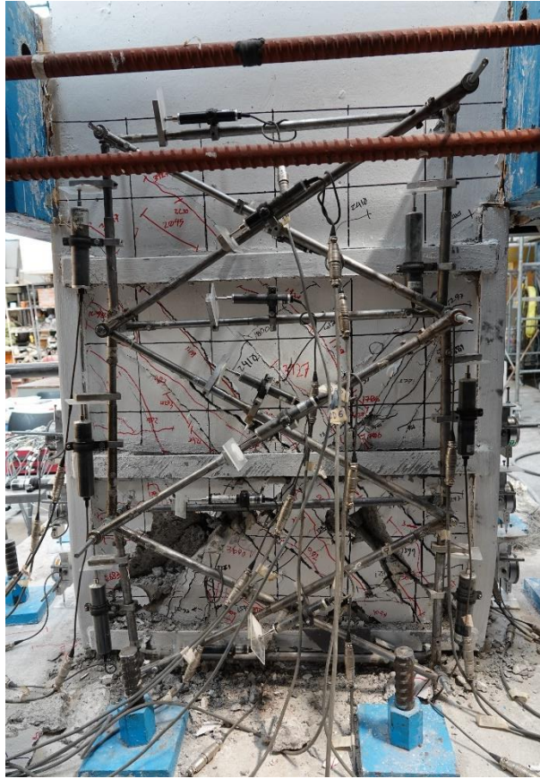
Fig. 3.3.152 Cara sur ( R=4\%(2) ) - Columna C-2 (Instituto de Ingeniería, 2021 - 2023)
