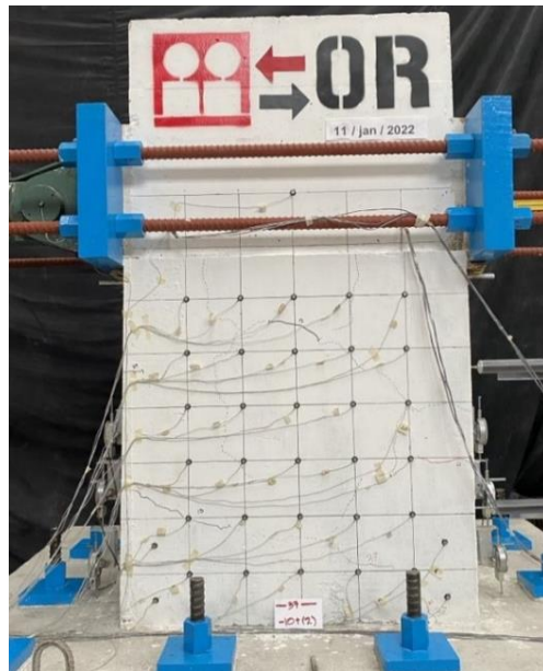
Fig. 3.3.36 Extensión de grietas cara norte - Columna OR (Instituto de Ingeniería, 2021 - 2023)
