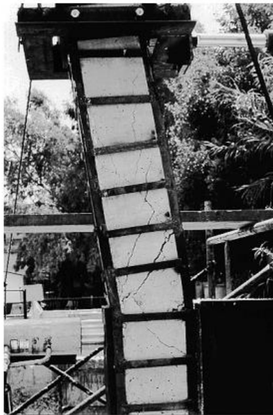
Fig. 1.1.4 Modelo y falla típica (González, 2007)
