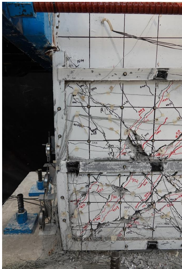
Fig. 3.3.155 Confinamiento de los ángulos noreste - Columna C-2 (Instituto de Ingeniería, 2021 - 2023)
