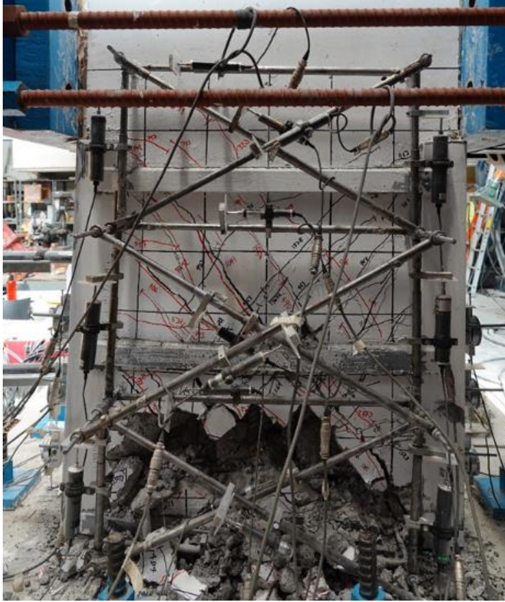
Fig. 3.3.205 Cara sur ( R=5.5\% ) - Columna C-4 (Instituto de Ingeniería, 2021 - 2023)
