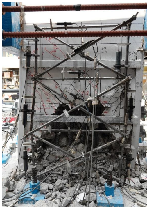
Fig. 3.3.163 Cara sur ( R=5\% ) - Columna C-2 (Instituto de Ingeniería, 2021 - 2023)
