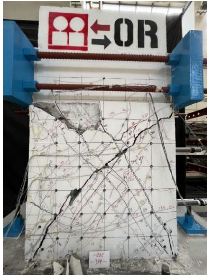
Fig. 3.3.49 Semiciclo ( R=-1.5\% ) - Columna OR (Instituto de Ingeniería, 2021 - 2023)
