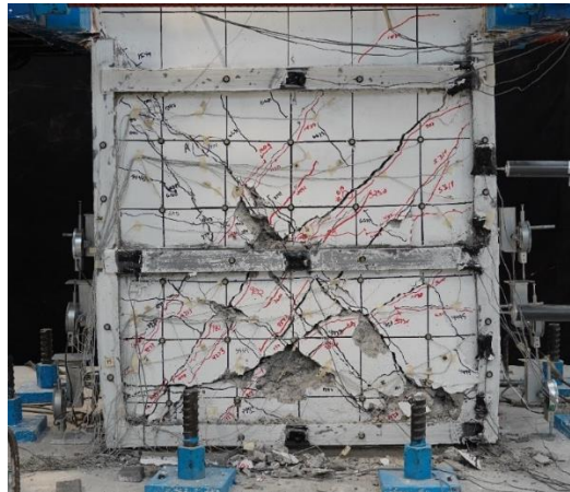
Fig. 3.3.157 Carga en cero posterior a los semiciclos de 4% - Columna C-2 (Instituto de Ingeniería, 2021 - 2023)
