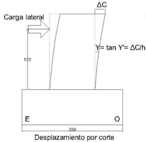
Fig. 3.2.2 Desplazamiento por corte (Instituto de Ingeniería, 2021 - 2023)
