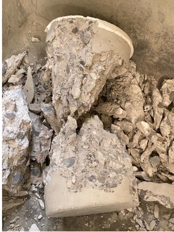
Fig. 2.6.5 Probeta cilíndrica con conos formados en ambos sentidos (Palma, 2022 - 2023)
