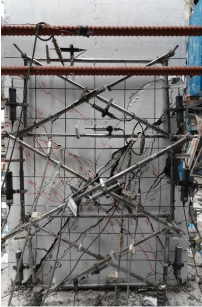
Fig. 3.3.93 Cara sur ( R=-2\% (2)) - Columna O* (Instituto de Ingeniería, 2021 - 2023)
