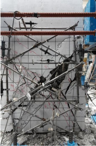
Fig. 3.3.100 Estado final cara sur - Columna O* (Instituto de Ingeniería, 2021 - 2023)
