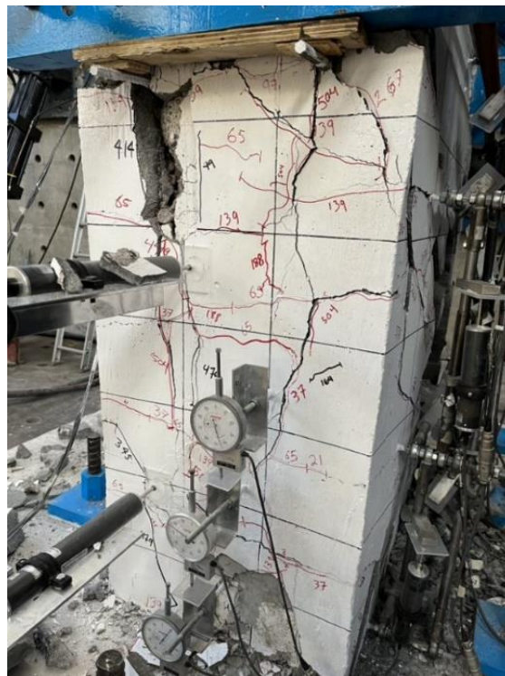
Fig. 3.3.56 Estado final cara oeste - Columna OR (Instituto de Ingeniería, 2021 - 2023)
