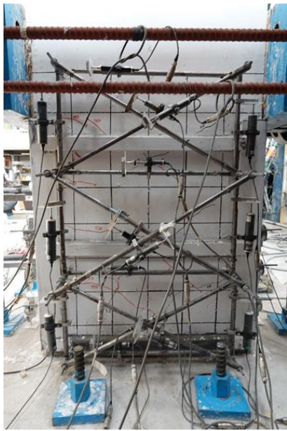
Fig. 3.3.188 Cara sur ( R=0.5\% ) - Columna C-4 (Instituto de Ingeniería, 2021 - 2023)
