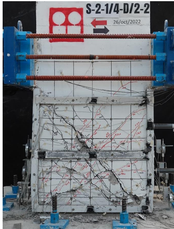
Fig. 3.3.149 Cara norte en carga cero después de la repetición de -4% - Columna C-2 (Instituto de Ingeniería, 2021 - 2023)
