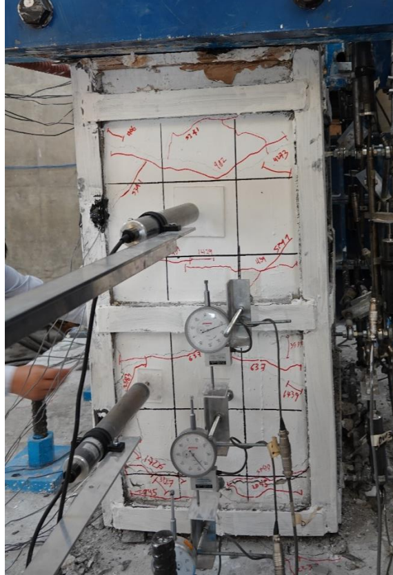
Fig. 3.3.146 Cara oeste ( R=-4\% ) - Columna C-2 (Instituto de Ingeniería, 2021 - 2023)
