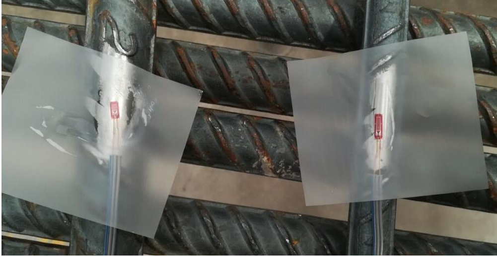
Fig. 2.5.5 Pegado de strain gauge (Instituto de Ingeniería, 2021 - 2023)
