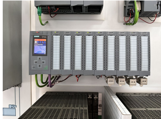
Figura 2.5 Controlador industrial utilizado como unidad de control
