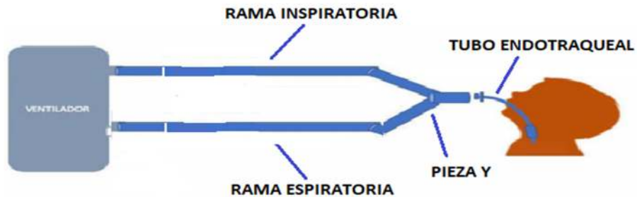
Figura 11. Conexión del circuito de ventilación modo invasivo
