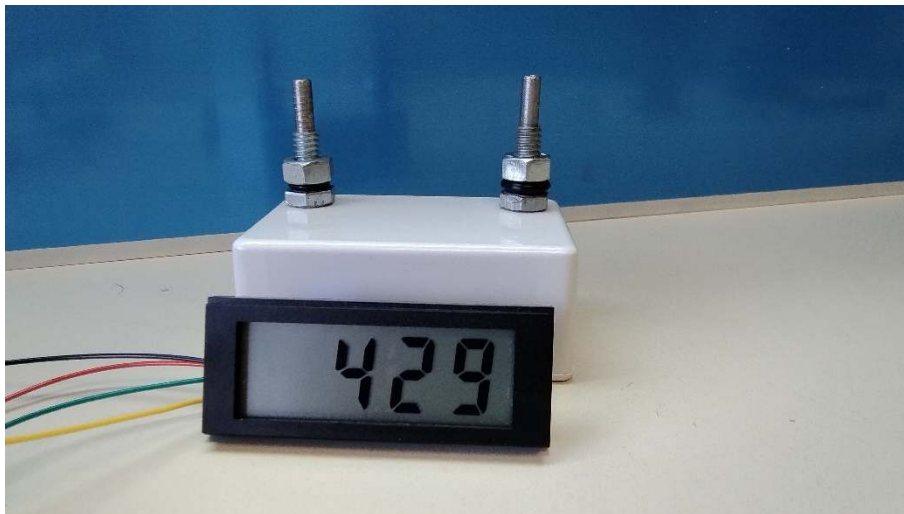
Figura 12. Sensor de \text{CO}_2 midiendo la concentración en el aire en ppm
