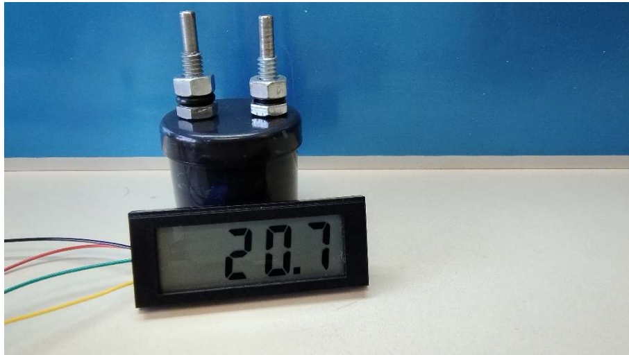
Figura 13. Sensor de O 2 midiendo la concentración en el aire en %
