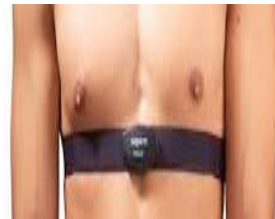
Figura 9 Pulsioxímetro de pecho
