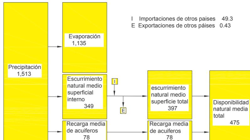
Fig. 1.3. Componentes del ciclo hidrológico (Valores medios anuales en km<sup>3</sup>)
