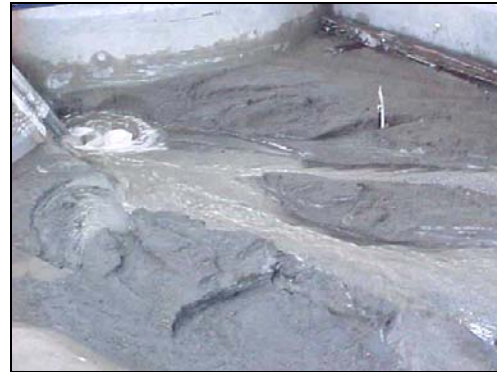
Evolución del desazolve, 33.57 min. en modelo.
