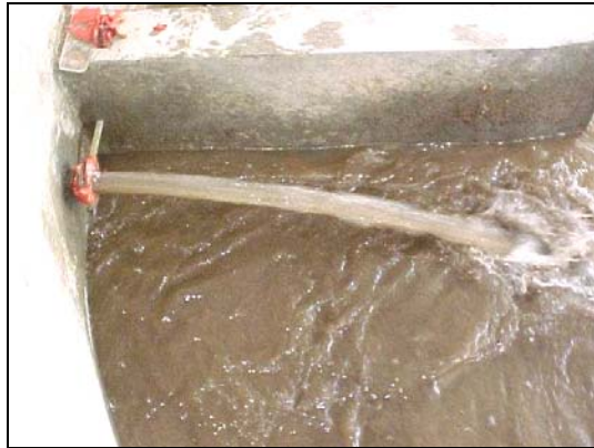
Desazolve de la Presa, 30 min. en modelo.
