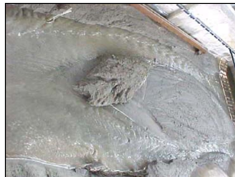
Evolución del desazolve, 45 min. en modelo.
