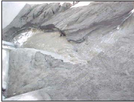
Evolución del desazolve, 33.17 min. en modelo.
