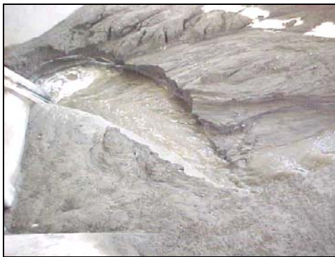
Evolución del desazolve, 45.38 min. en modelo.
