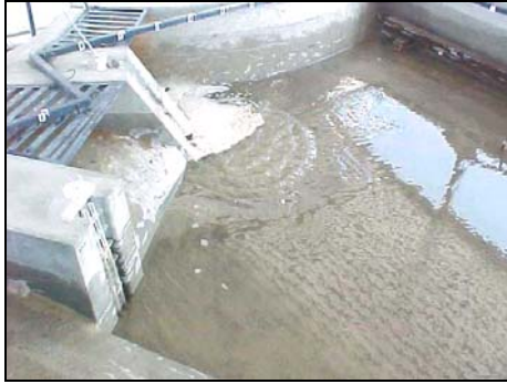
Evolución del desazolve, 12.20 min. en modelo.
