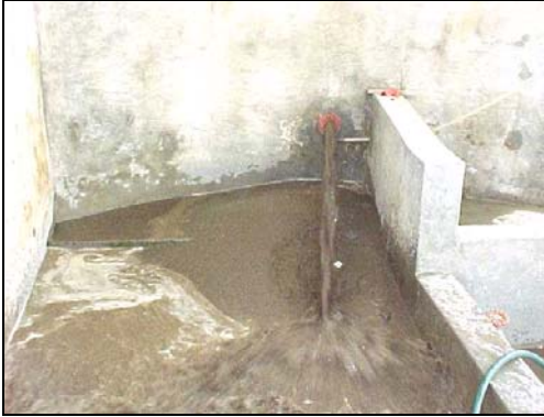
Desazolve de la Presa, 5.2 min. en modelo.
