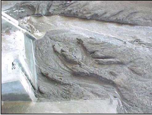
Evolución del desazolve, 18.20 min. en modelo
