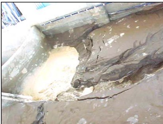
Cono de socavación, 93,3 min. en modelo
