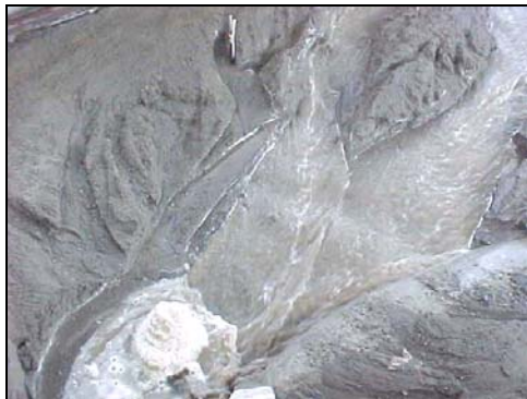
Evolución del desazolve, 34.57 min. en modelo.
