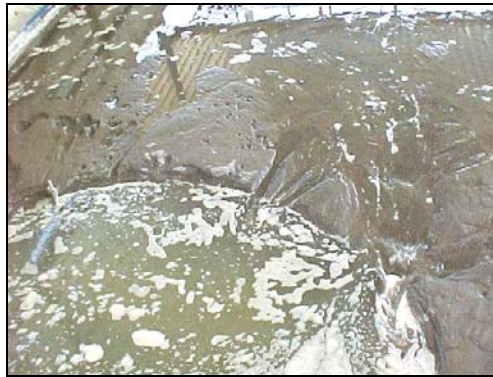
Cono de socavación, 55 min. en modelo.
