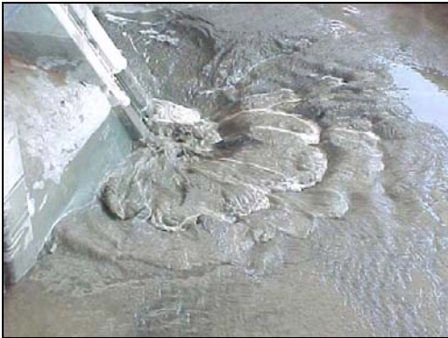
Evolución del desazolve, 14.20 min. en modelo
