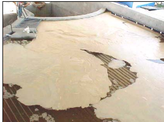
Desazolve de la Presa , 3,08 min. en modelo.
