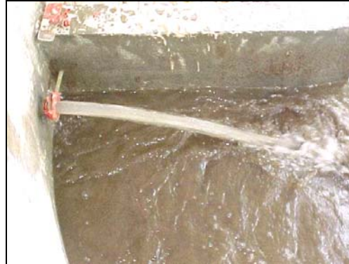
Desazolve de la Presa, 45 min. en modelo.
