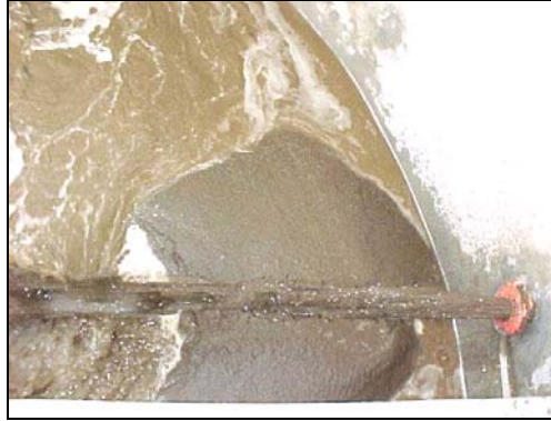
Desazolve de la Presa, 10 min. en modelo.
