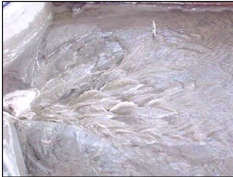
Evolución del desazolve, 25.57 min. en modelo.
