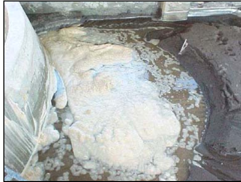
Cono de socavación, 80 min. en modelo.
