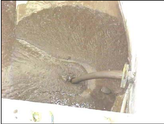
Desazolve de la Presa , 1,52 min. en modelo.
