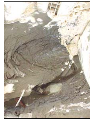
Cono de socavación, 90 min. en modelo.
