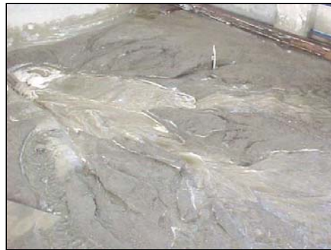
Evolución del desazolve, 27.52 min. en modelo.
