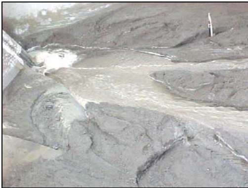
Evolución del desazolve, 32.57 min. en modelo.
