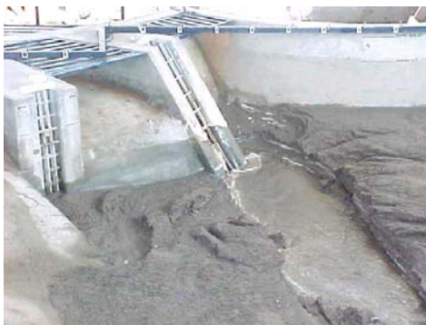
Evolución del desazolve, 50.00 min. en modelo
