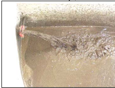
Desazolve de la Presa, 16 min. de operación del modelo
