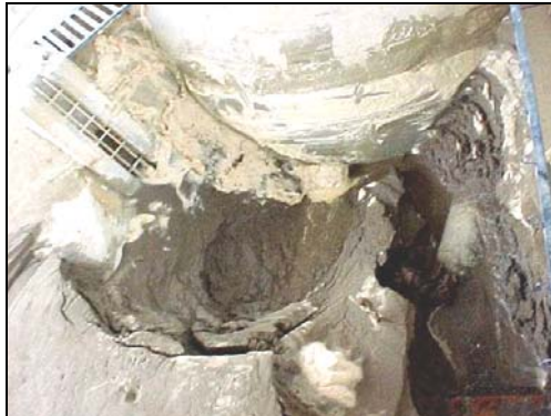
Cono de socavación, 90 min. en modelo.
