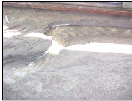
Evolución del desazolve, 40.38 min. en modelo.
