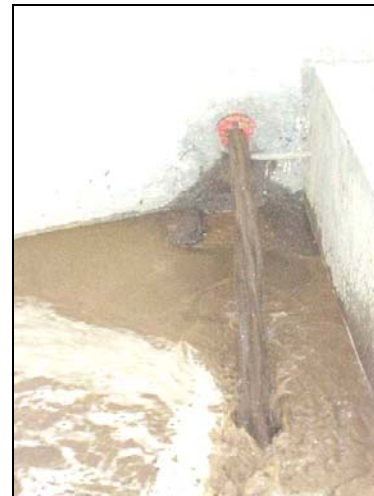
A los 12 min. de operación del modelo se inicia el desazolve de la Presa.
