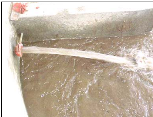
Desazolve de la Presa, 40 min. en modelo.
