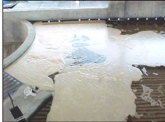
Desazolve de la Presa , 1,52 min. en modelo.
