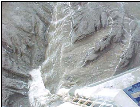
Evolución del desazolve, 16.20 min. en modelo
