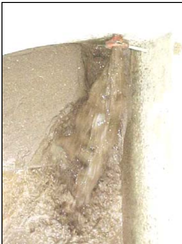
A los 12 min. de operación del modelo se inicia el desazolve de la Presa.
