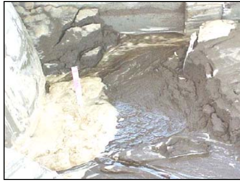
Cono de socavación, 95 min. en modelo.
