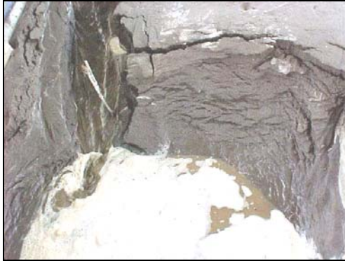
Cono de socavación, 55 min. en modelo.
