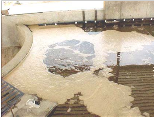
Desazolve de la Presa, 10 min. en modelo.
