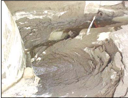
Cono de socavación, 85 min. en modelo.
