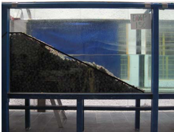
Figura 0.3 Daño del dique a una altura de ola de 20 cm
