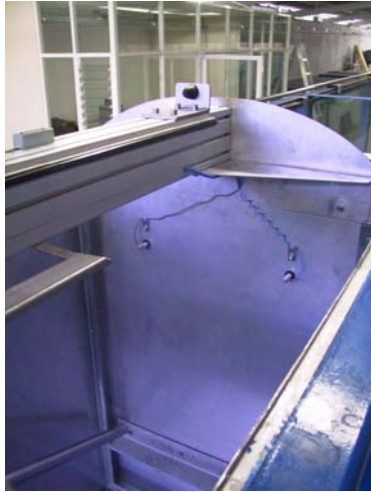
Figura C.2 Generador de oleaje (Instituto de Ingeniería, UNAM)
