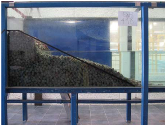
Figura 0.5 Daño del dique a una altura de ola de 22 cm
