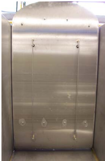
Figura C.4 Sensores en la parte frontal de la paleta, utilizados por el sistema de absorción, Laboratorio de Olas, II-UNAM
