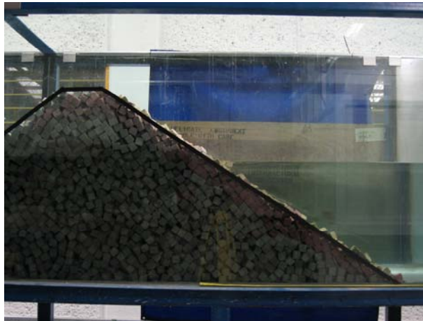
Figura 0.9 Perfil inicial del dique de talud 1.5:1
