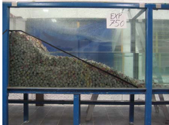
Figura 0.7 Daño del dique a una altura de ola de 24 cm
