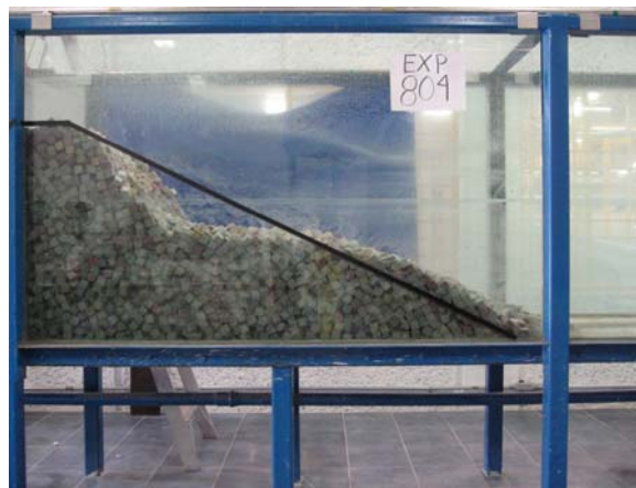
Figura 0.8 Daño del dique a una altura de ola de 26 cm
