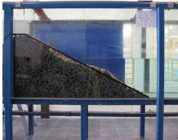
Figura 0.2 Daño del dique a una altura de ola de 19 cm
