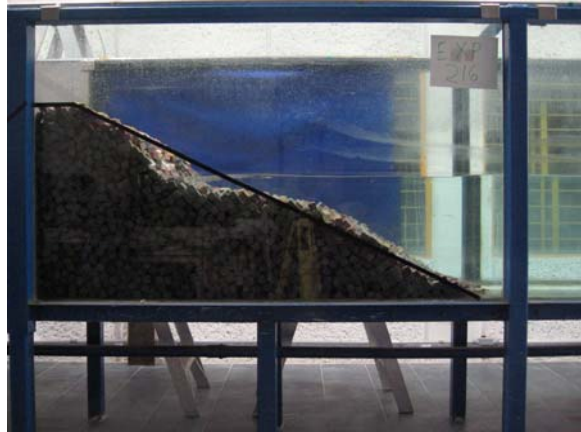
Figura 0.4 Daño del dique a una altura de ola de 21 cm
