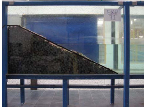
Figura 0.1 Daño del dique a una altura de ola de 18 cm.
