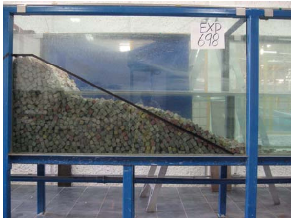
Figura 0.6 Daño del dique a una altura de ola de 23 cm
