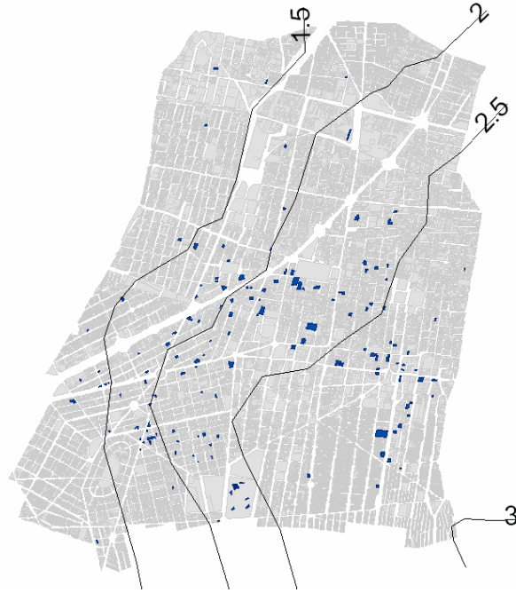
Figura 3.3 Estructuras dañadas en la delegación Cuauhtémoc con período estructural calculado con RSMex® coincidente con los períodos del suelo
