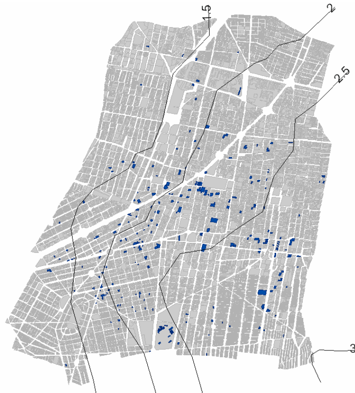
Figura 1.21 Distribución de las estructuras dañadas por los sismos de septiembre de 1985
