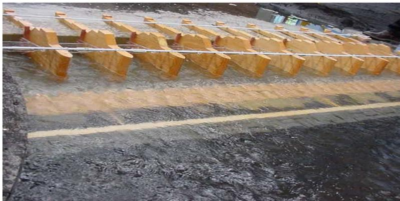
Foto 2.6.13 Funcionamiento del modelo prolongando el tanque amortiguador.
