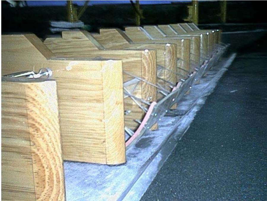
Fig. 3.1.5 Vista del tanque amortiguador y umbral aguas abajo de las compuertas.
