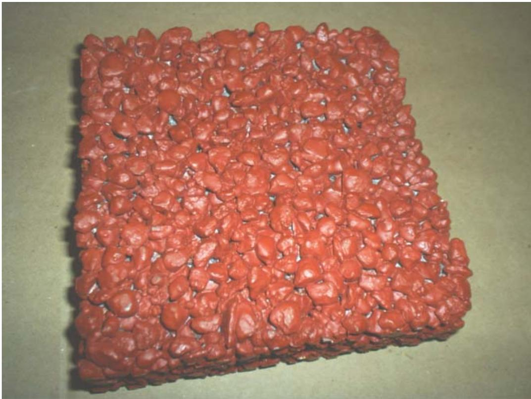
Fig. 2.1. Bloque de concreto permeable
