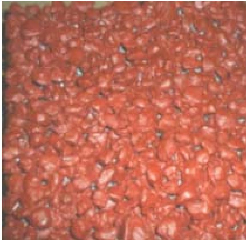
Fig. 3.6 concreto permeable, donde se aprecia su porosidad.
