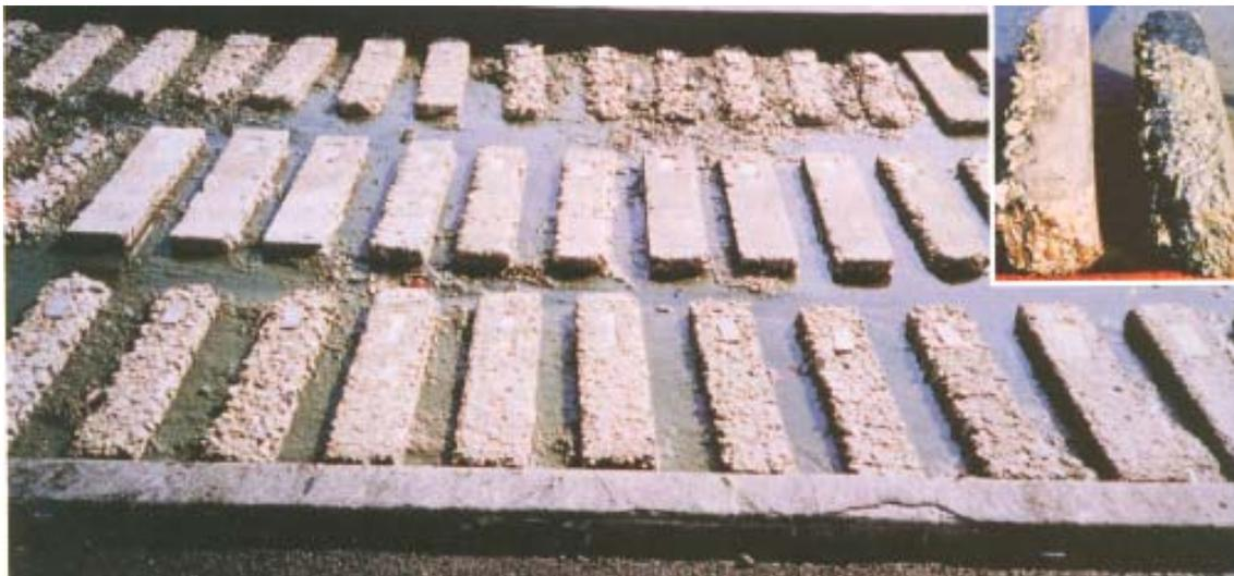
Fig. 3.15 Vigas de concreto después de muchos años de exposición a un suelo de alta concentración de sulfatos
