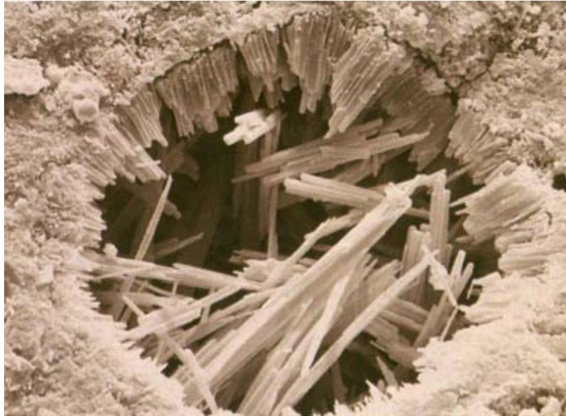
Fig. 3.18 Depósitos blancos de etringita secundaria en un vacío.
