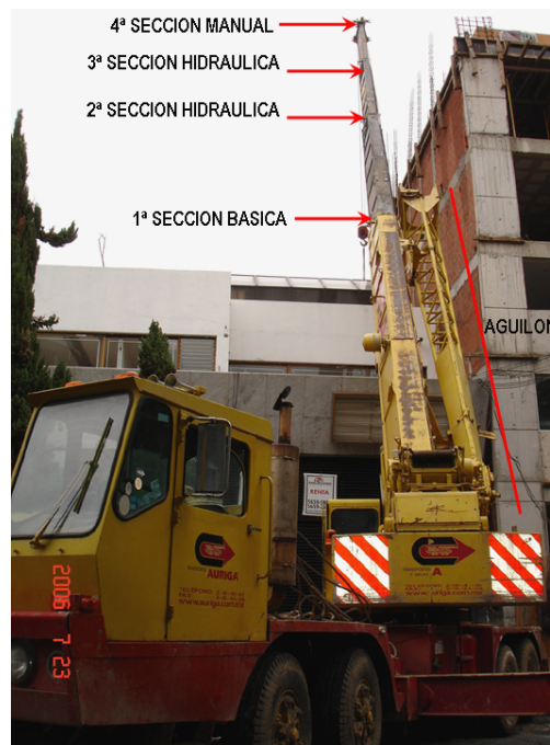
Imagen 4.6 Secciones de pluma de grúa hidráulica
