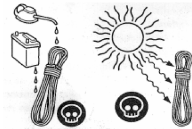
Fig. 2.8 Agentes que deterioran una cuerda
