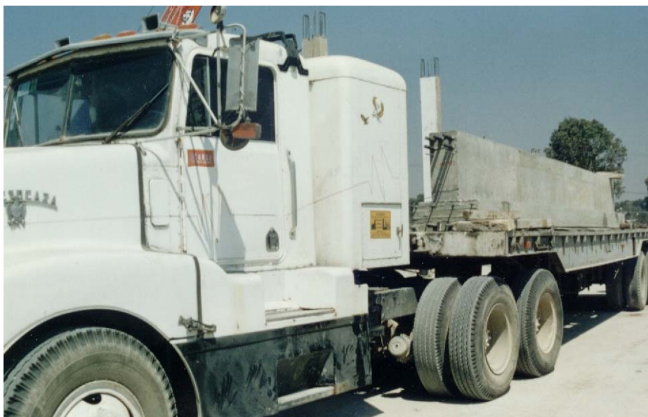
V.3.2. Traves colocadas en trailer de transporte.
