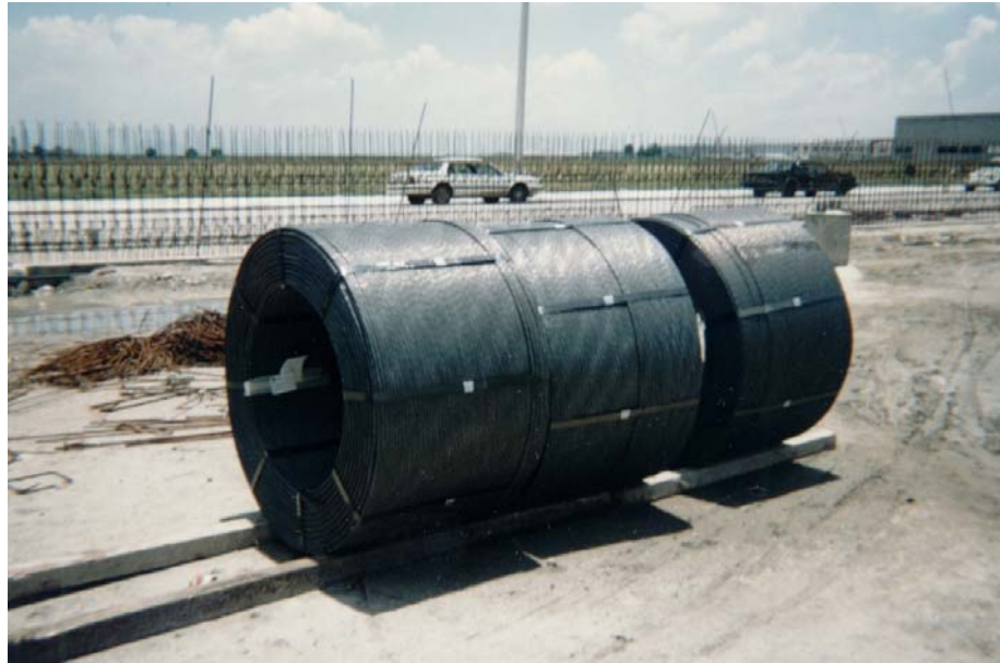
III.5.1. Torón trenzado de 7 hilos de 1/2".
