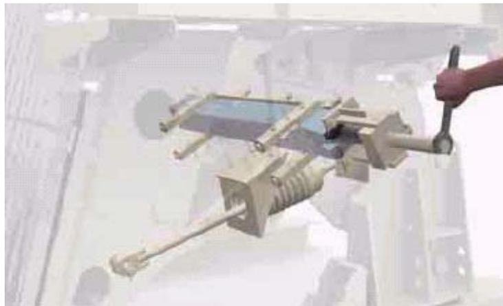
El ajuste de la trituradora puede hacerse a mano y rápidamente, con herramientas que se suministran con la trituradora y sin necesidad de manejar suplementos pesados. Otra posibilidad es cambiar el ajuste de la trituradora desde una ubicación remota, incluso cuando la trituradora está llena. El sistema también resulta efectivo a la hora de vaciar la cavidad de la trituradora si llega a pararse con carga debido a interrupciones del suministro eléctrico.
