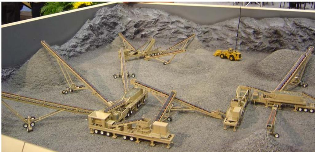
*Fig. IV.18 Maqueta de planta de trituración de agregados.*
