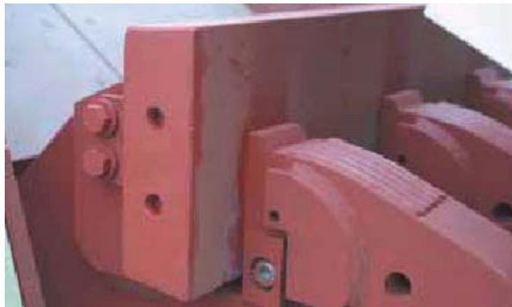
*Fig. II.29 Sistema de sujeción de martillos.*
