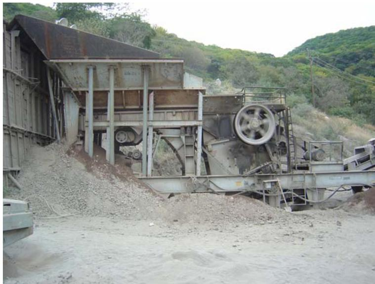
Fig. IV.23 *Planta de trituración móvil primaria TelSmith*
