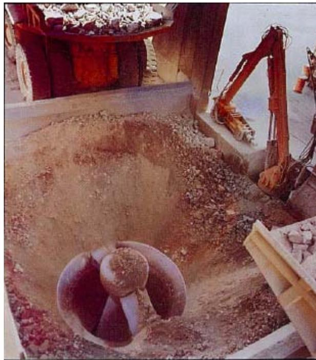
*Fig. II.15 b) Detalle de abertura de trituradora giratoria.*
