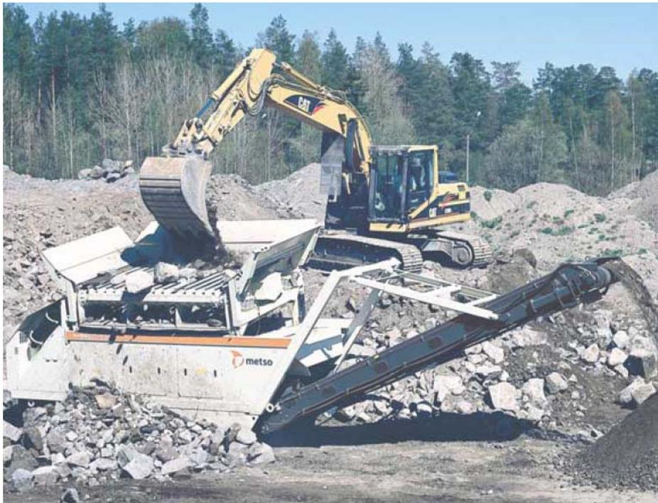
*Fig. III. 20 Criba vibratoria móvil Metso.*
