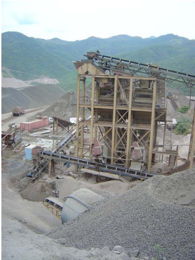
*Fig. IV.14 Otra vista del equipo de cribado terciario.*
