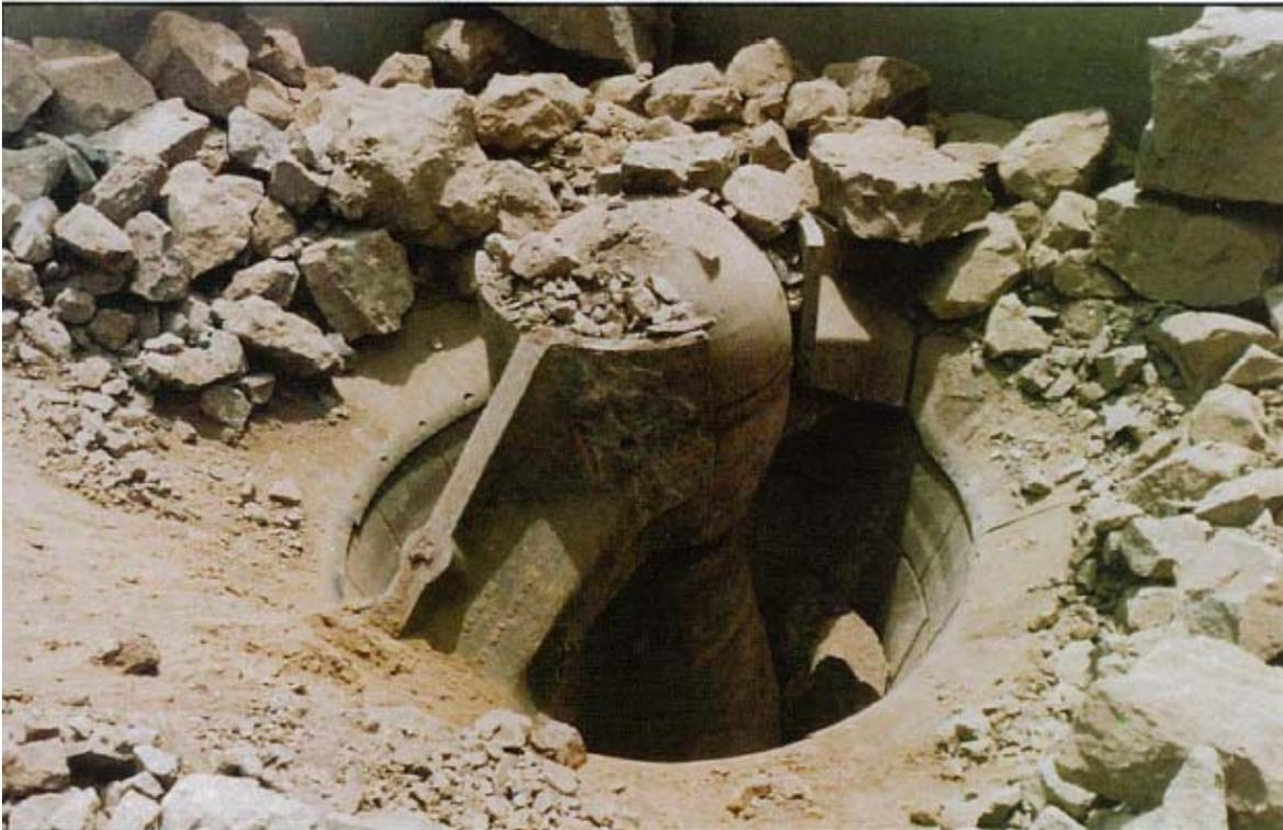
*Fig. II.15 a) Detalle de abertura de trituradora giratoria.*
