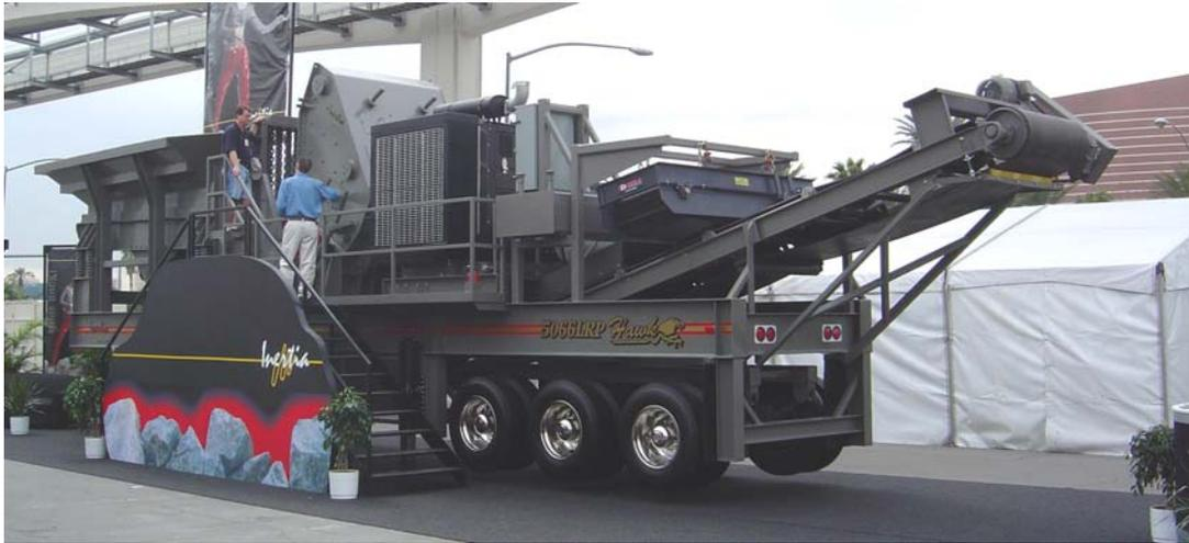
Hoy en día con los avances en el diseño de ingeniería de trituradoras se pueden tener equipos móviles que satisfacen requerimientos del mercado a menores costos y que se montan en conjunto con alimentadores, cribas e instaladores de potencia para un mejor funcionamiento.
