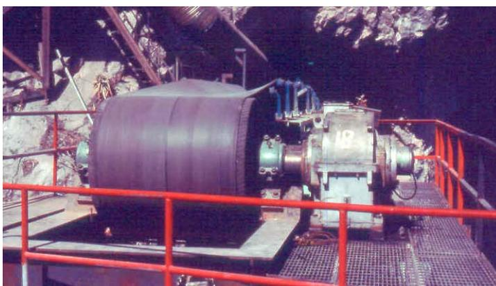
*Fig. III 34. Propulsión de una banda caguama*
