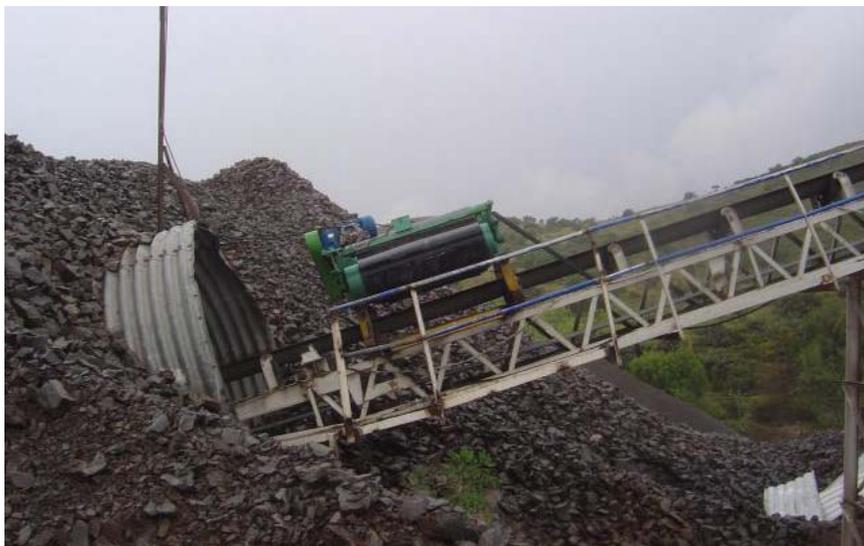
*Fig. III. 37 a) Imán sobre banda transportador.*
