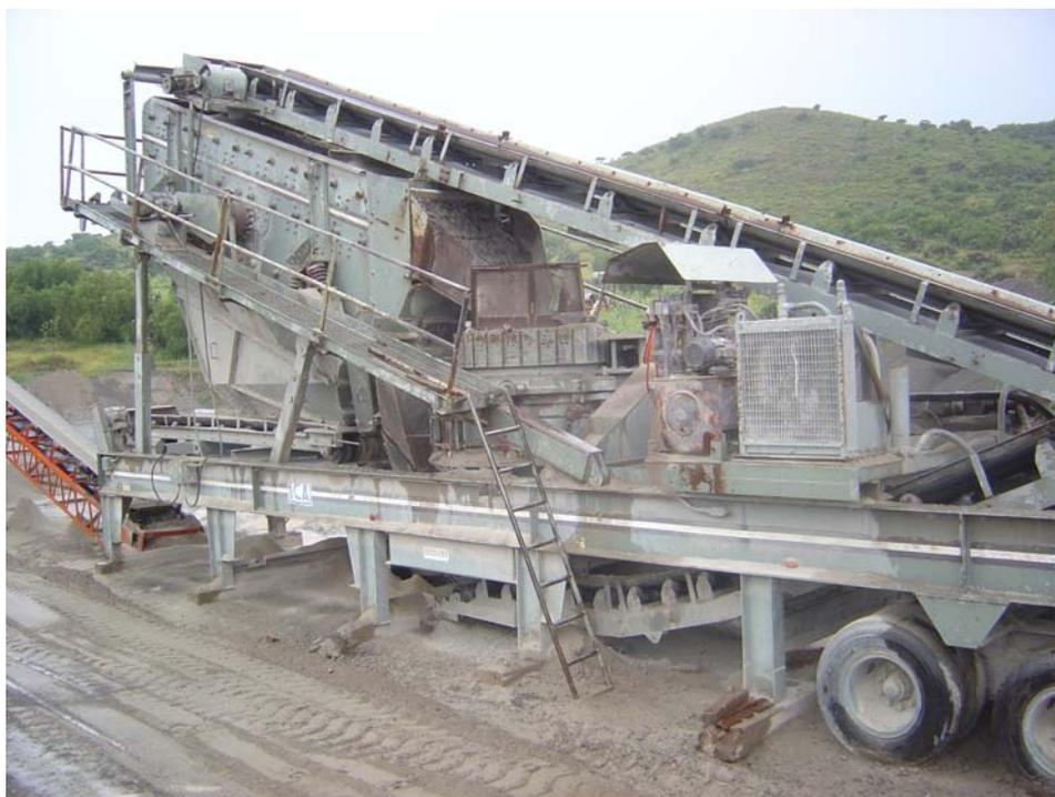
*Fig. III. 22 Criba vibratoria TelSmith.*
