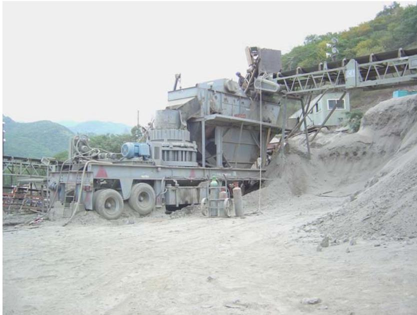
Fig. IV.24 *Equipo móvil de trituración secundaria Telsmith*
