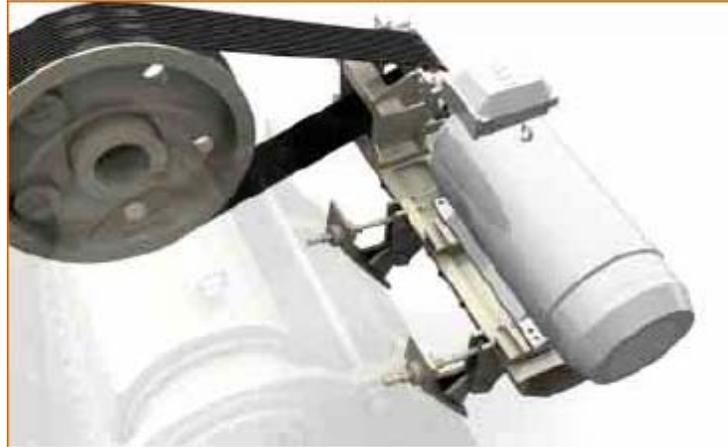
Los protectores de los volantes de inercia (fig. II.12) se fijan con pernos a las placas laterales de la trituradora y protegen a los operadores de las piezas móviles que pueden resultar peligrosas. Las ventanas de inspección y las puertas de acceso permiten a los técnicos inspeccionar y darle mantenimiento a la trituradora. Su uso también permite un acceso más cómodo a la trituradora, dado que los protectores no están apoyados en la plataforma de servicio.
