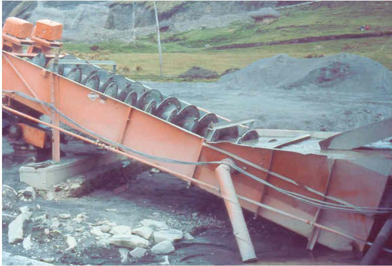
*Fig. III.42 Tanque lavador*
