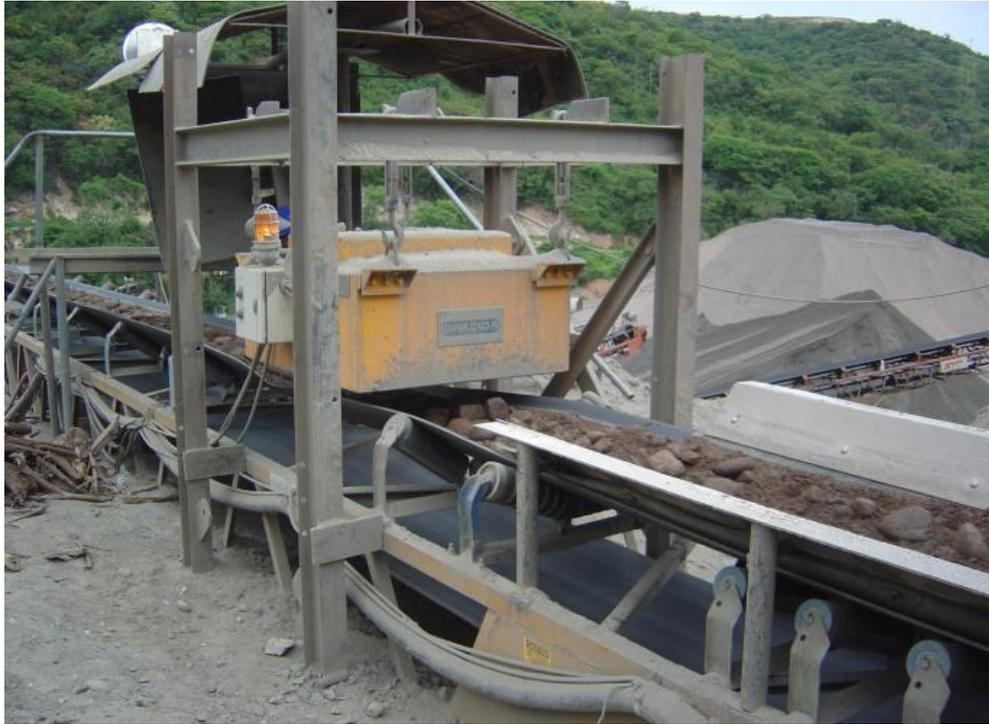
*Fig. III.37 b) Imán sobre banda transportadora.*
