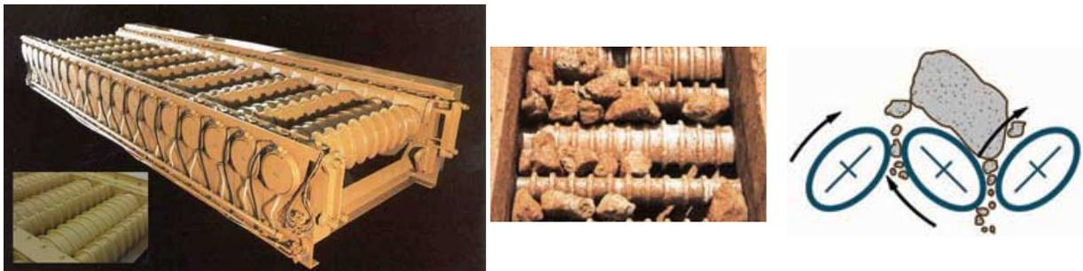
*Fig. III.17 Funcionamiento del alimentador oscilante.*
