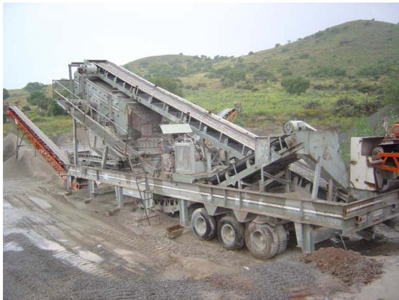
Fig. IV.25 *Equipo móvil de trituración secundaria Telsmith*
