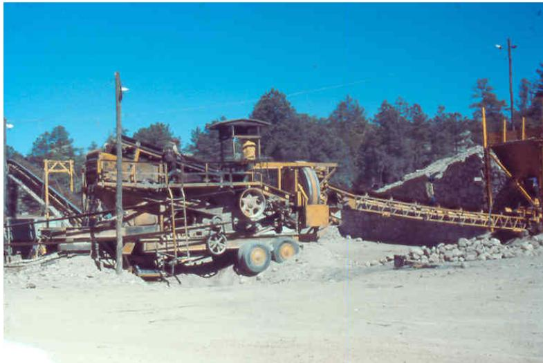
Fig. IV.21 Planta de trituración dual
