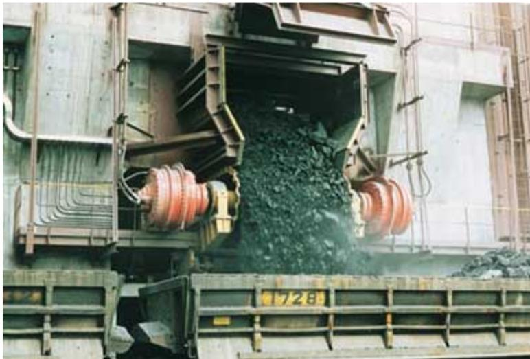
*Fig. III.10 Descarga a un alimentador de mandil (abajo).*
