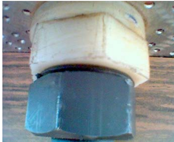
Figura 3.9. Empaque “o-ring” en cada una de las conexiones hidráulicas que conforman el biofiltro.
