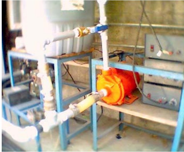
Figura 3.16. Sistema de alimentación de aguas residuales en la tercera etapa de experimentación con una bomba de 1/4 de HP de corriente alterna.
