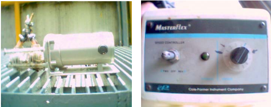
Figura 3.15. Sistema de alimentación de aguas residuales en las dos primeras etapas de experimentación: a) motor "Cole-Parmer", b) fuente de poder de voltaje variable.
