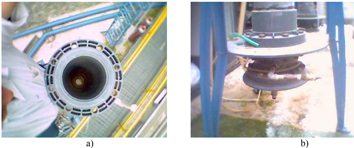
Figura 3.5. Reactor piloto de 5.0 m de altura, a) vista superior, b) bajo dren.
