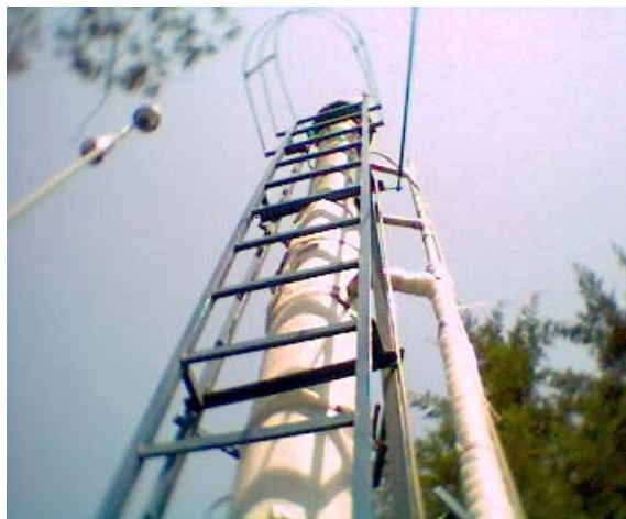
Figura 3.7. Tubo de PVC que confina el lecho de tezontle asegurada a una estructura trípode.
