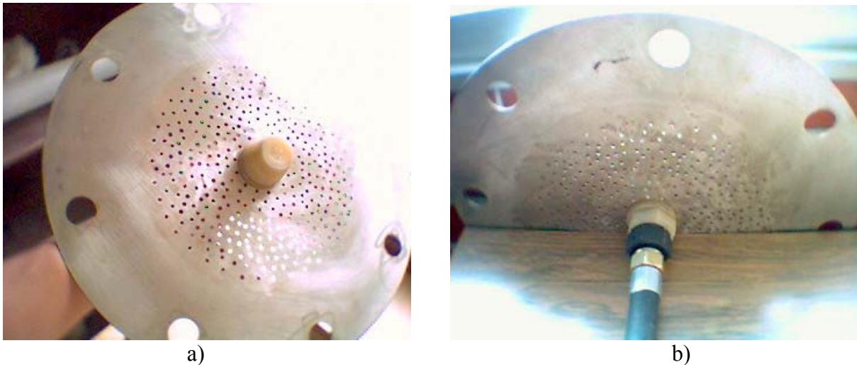
Figura 3.11. Placa de aluminio perforada para soportar el medio filtrante y permitir el paso del agua, a) cara superior, b) cara inferior.
