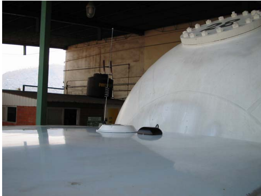
Figura 30. Imagen de las antenas de la tarjeta CreataLink (izquierda) y GPS (derecha) sobre el toldo de un autotanque.
