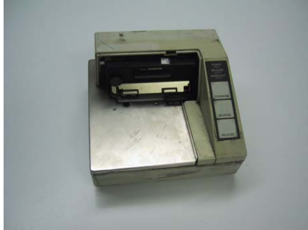
Figura 9. Impresora que tienen a bordo los autotanques para la impresión de las notas.
