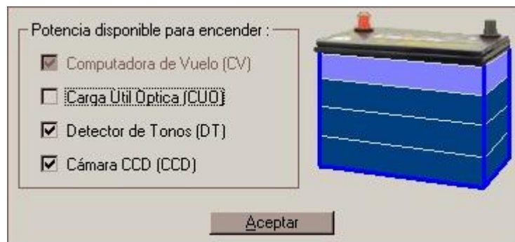
Figura 2.8 Programación de la potencia disponible en el SP para encender cargas útiles
