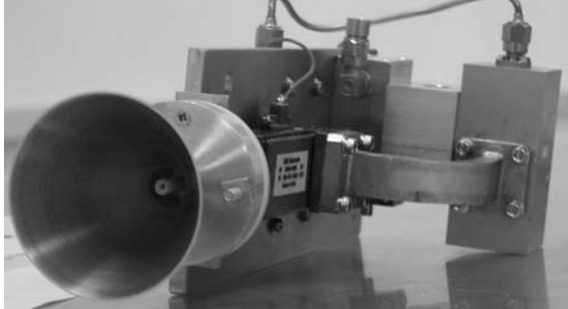
Figura 1.5 Antena utilizada para el experimento de propagación de señales en banda Ka
