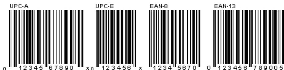
Fig. 1.4. Código de barras UPC-A, UPC-E, EAN-8 y EAN-13.
