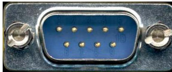
Figura 3.4. Fotografía de un conector DB9 macho.
