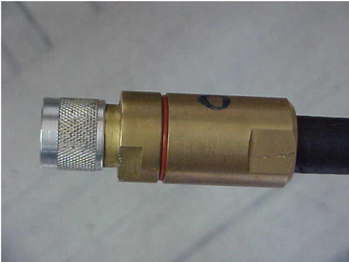
Figura IV.3: Cable Tipo Heliax con el Conector N.
