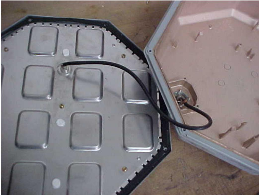
Figura IV.2(a): Cable RG142 del panel al conector N. Dentro de la Antena.
