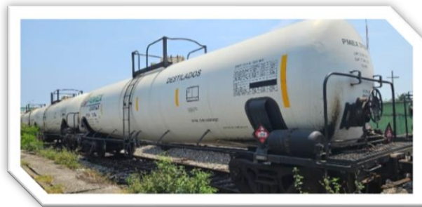
Figura II.50; Fotografía carrotanque no presurizado.
