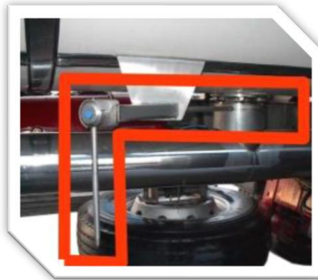
Figura II.29; Fotografía válvula de palanca.
