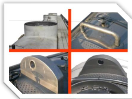
Figura II.36; Fotografía de protección antivuelco de un autotanque.
