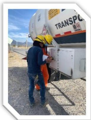
Figura VI.15; Fotografía inspección de los sellos de seguridad del autotanque.
