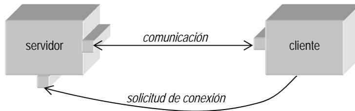
Figura 1.4. Protocolo con conexión.
