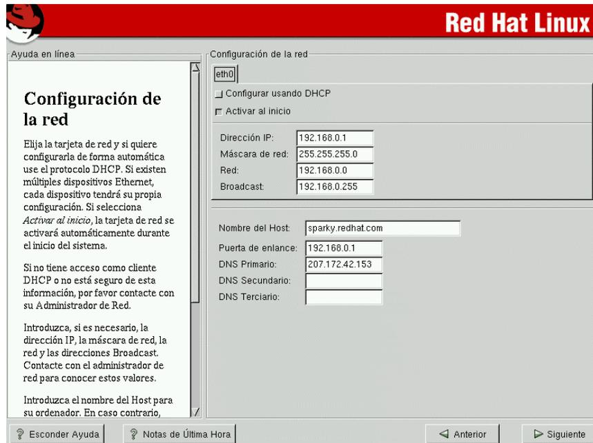
Fig. : C.11 Configuración de red
