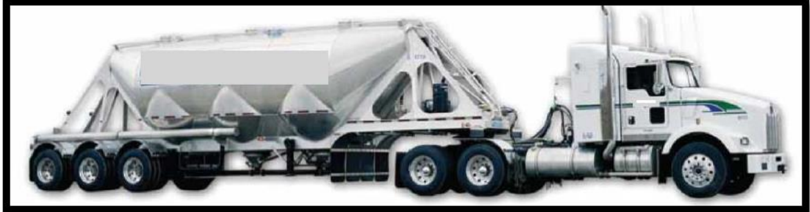
Figura 2.1 Tráiler de transporte de apuntalante. 3
