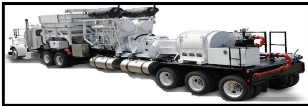
Figura 2.4 Bombas de alta presión. 3
