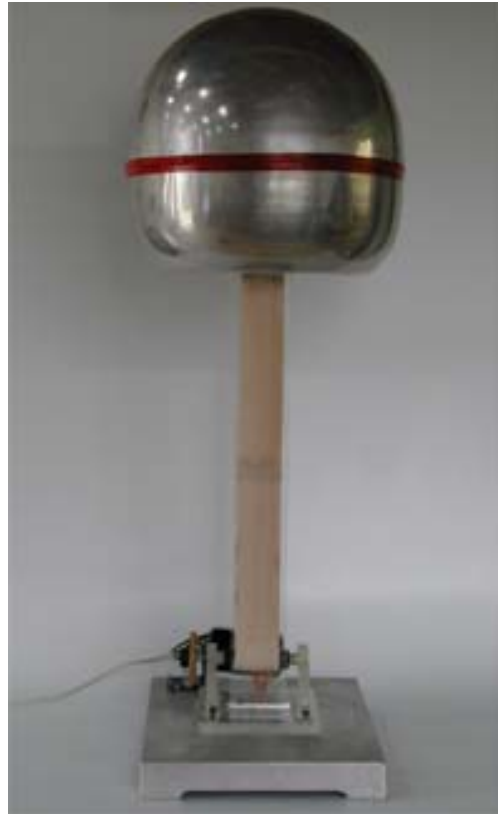
Fig.1. Generador Van de Graaff con soporte de acrílico que permite observar el movimiento de la banda transportadora de cargas
