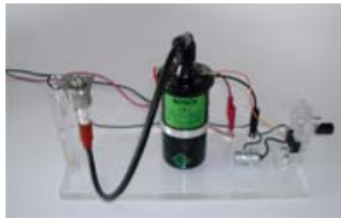
Fig.32. Circuito análogo al de encendido de los autos
