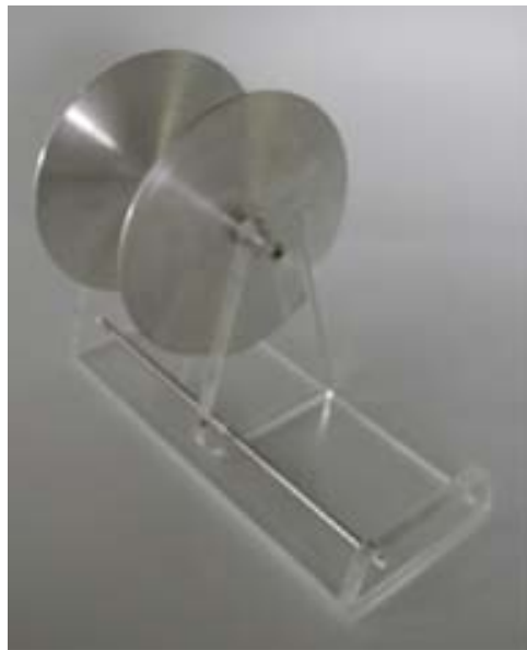
Fig 16. Capacitor variable con movimiento que permite variar el área entre las placas
