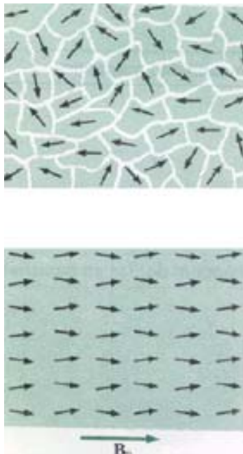
Fig 22. La primera figura muestra la orientación aleatoria de los dominios, en ausencia de magnetización, la segunda muestra la alineación de los dominios ante la magnetización.
