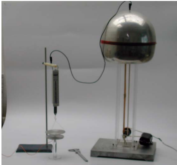
Fig 17. La figura muestra dos platos capacitivos, separados entre sí, uno de ellos se encuentra conectado al generador y está sujeto de un dinamómetro, y el otro, está conectado a Tierra
