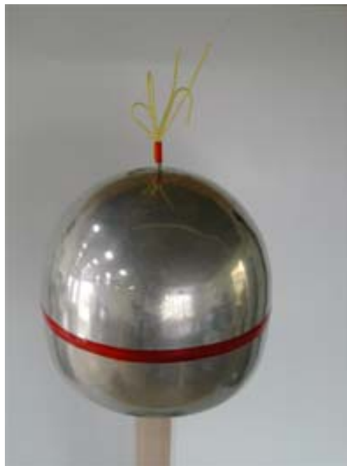
Fig.2. Conector con hilos de estambre, colocado en la parte superior del Generador Van de Graaff
