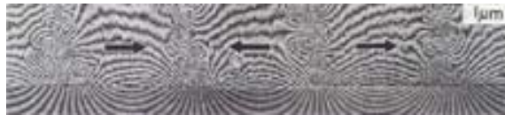
Fig 23: Se muestran los dominios magnéticos de un cassette.
